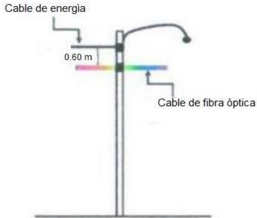
Poste de Baja Tensiòn
