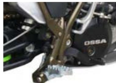
Giunture e cuscinetti del pedale del freno posteriore
