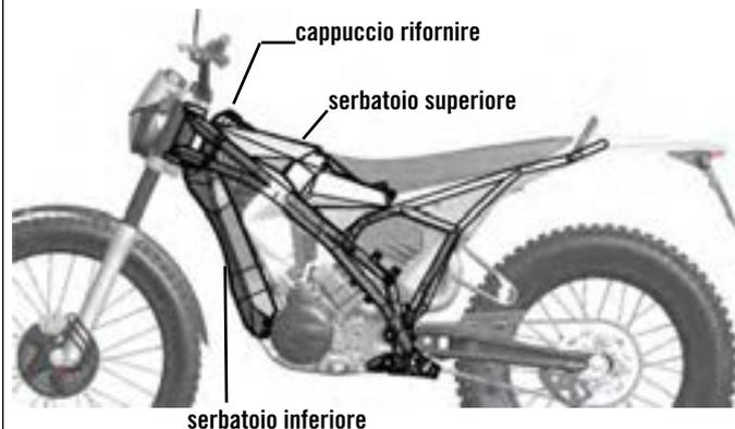
Per accedere ad alcune parti del motore o il cablaggio, è necessario preventivamente sollevare il serbatoio superiore del carburante.
