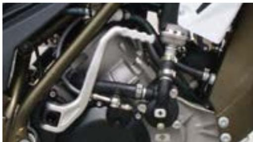
Giunture del pedale di avviamento del motore
