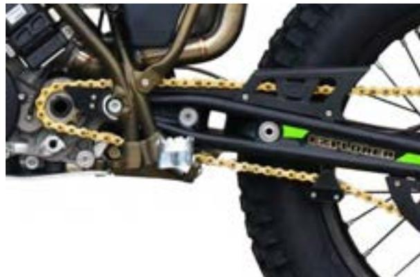
Catena di trasmissione e molle del tensore
