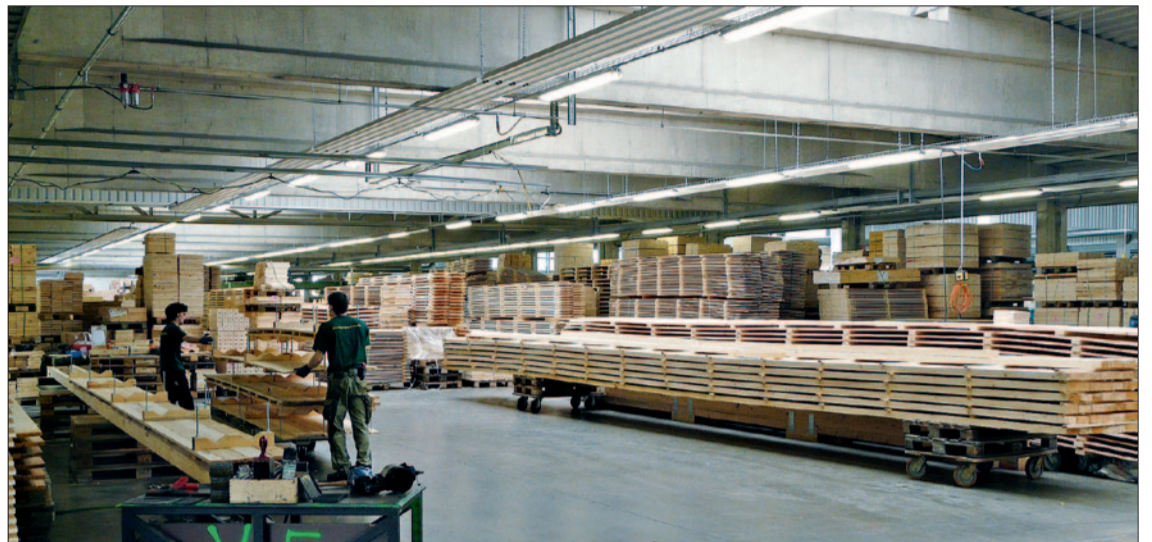
Standardmäßig werden bei Schulte bis zu 14 m lange Verpackungen in Serie gebaut. Auf solche Längen und große Breiten ist auch der Schnittholzeinkauf ausgerichtet; ebenso die eigene Trockenkammer, die v. a. in den Sommermonaten im Einsatz ist, um der Holzheizzentrale Wärme abzunehmen und Altholzreste zu entsorgen.
