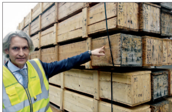
Engelbert Schulte ist stolz auf die Nachhaltigkeit dieser Mehrweg-Holzverpackungen, die in ihrem „Leben“ dank Niettechnik und Reparatur teilweise bis zu 50 Umläufe schaffen, wie Markierungen nach jeder Reparatur zeigen.
