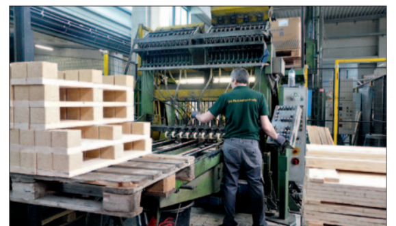
Sonderpalettenproduktion auf robusten Spezialmaschinen, die teilweise schon sehr lange ihren Dienst tun. Bei kleinen Losgrößen haben diese Maschinen immer noch ihre Existenzberechtigung neben den stärker automatisierten Anlagen für die Serien- oder Massenfertigung.
