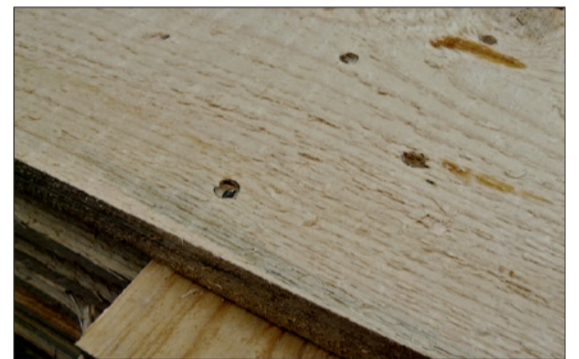
Bei Schulte wird vernietet, nicht vernagelt. Das macht die Verpackungen stabiler, was gerade im Verkauf von Kisten, die als Rückfracht im Container wieder zum Hersteller zurückkommen, ein wichtiges Argument ist.
