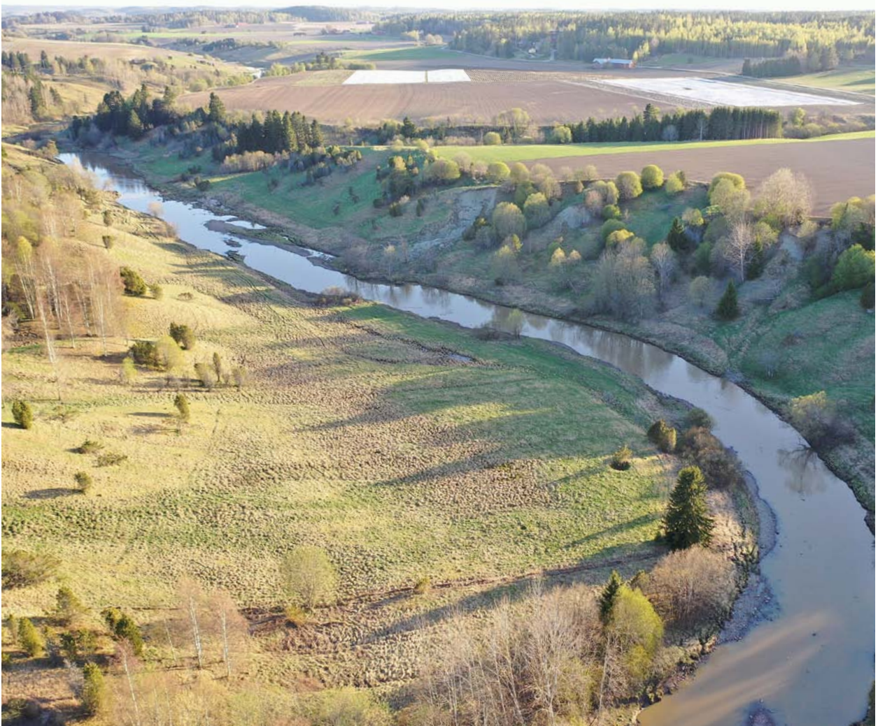
Kuva 6. Saviset joenpenkat vyöryvät helposti ja koko Paimionjoen varsi onkin erityisen eroosioherkkää. Nämä maanvyörymät sijaitsevat Paimiossa Askalasta alajuoksulle. KUVA OSKARI SUMMANEN
