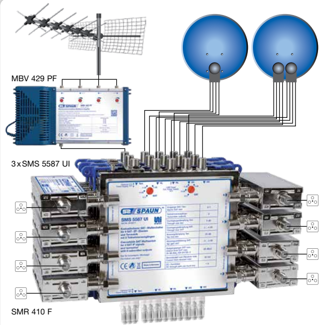
3 SAT Positionen (12 SAT - ZF - Ebenen) und Terrestrik für 8 Teilnehmer.
