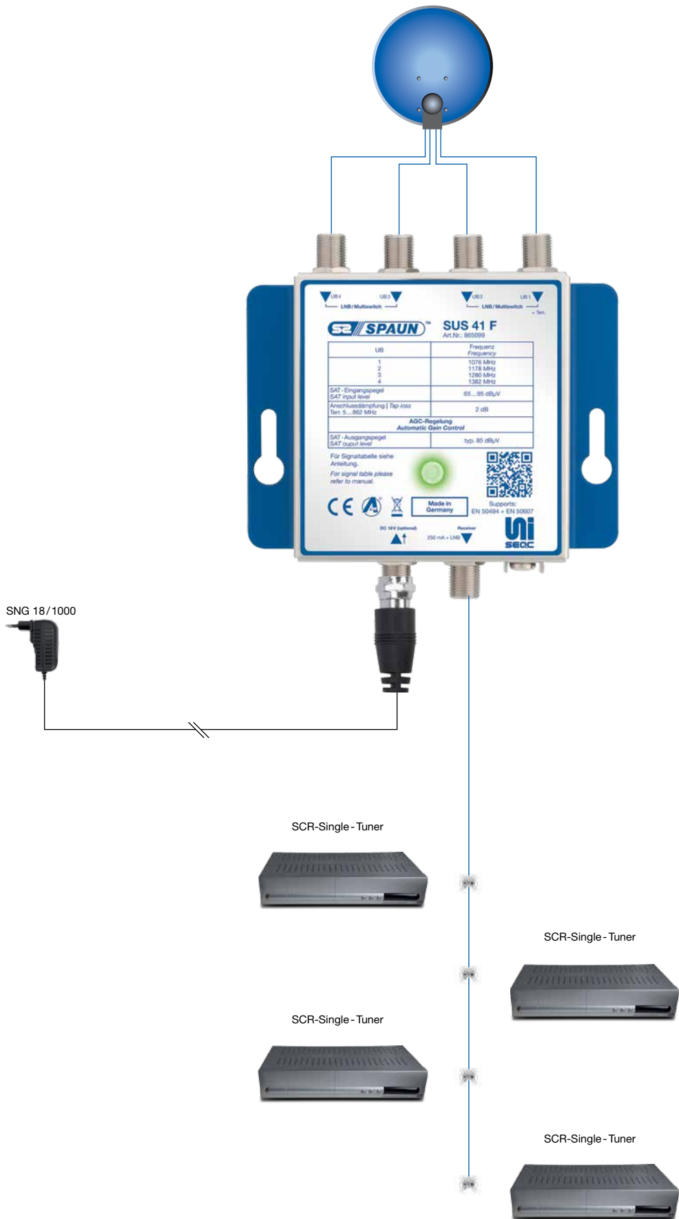
QUAD - LNB auf eine Ableitung für vier Einkabelreceiver. (EN 50494 oder EN 50607)
