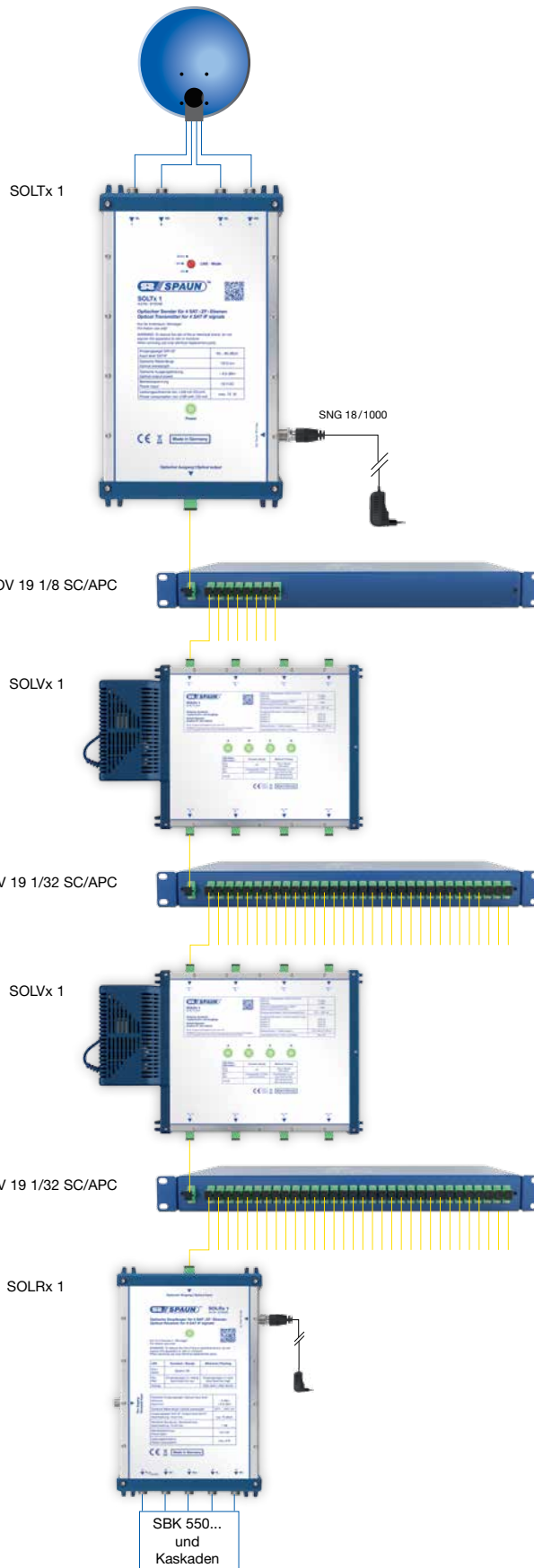
Optische Verteilung von 4 SAT - ZF - Ebenen auf 8192 optische Knotenpunkte mit anschließender Kaskadenverteilung.
