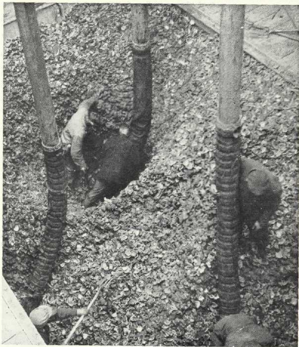
Opzuigen van de copra door de elevators uit het ss Polydorus in de lichter te Amsterdam.
