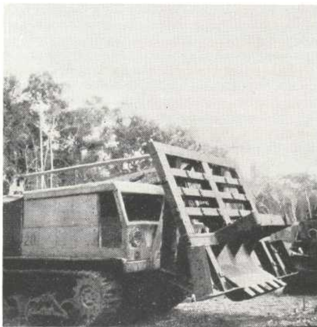
Omgebouwde "canon puller" M 4 met duwraam en 5-tandig stumperblad, waarboven een vierkante stalen ram is gelast.
