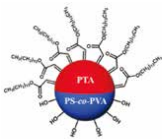
图1 ❖ Janus颗粒表面化学图（左）和Janus颗粒的扫描电子显微镜（SEM）图像（右）。
