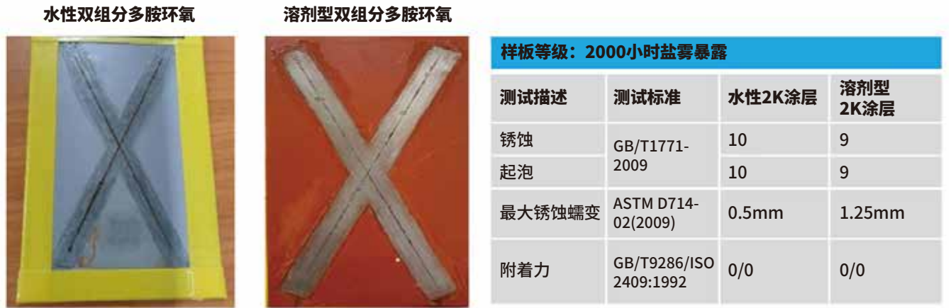
图 12 ❖ 2000小时盐雾暴露 (ASTM B117) 后, 水性涂层样板和溶剂基涂层样板的外观。
