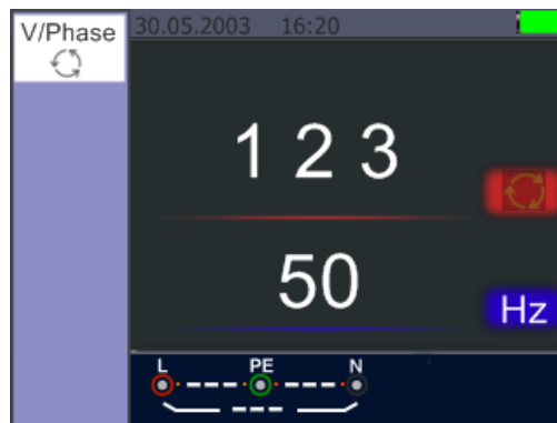
Richtige Phasensequenz L1, L2, L3 (rechtsdrehendes Drehfeld)
