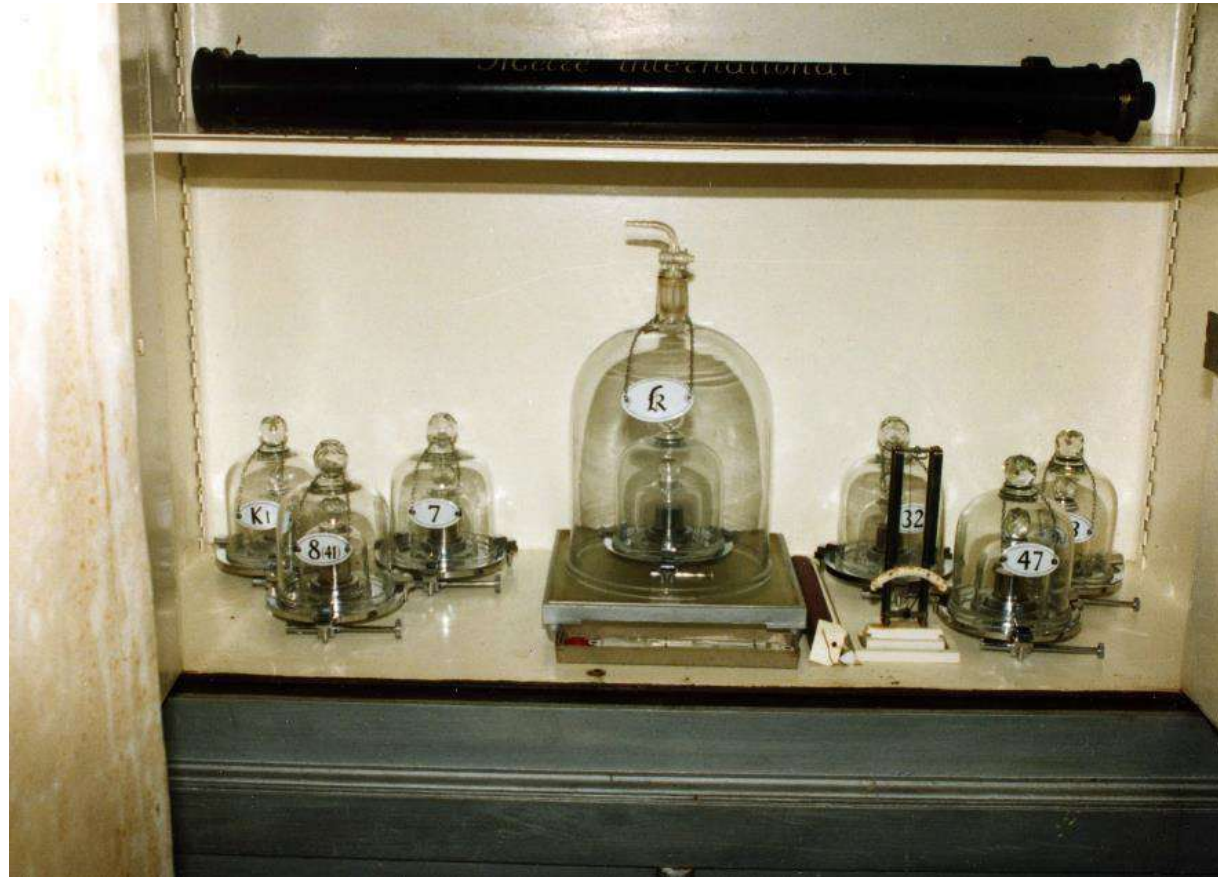
Le prototype international du kilogramme \mathcal{K} (IPK) et ses six copies officielles témoins
