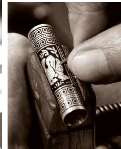
Die Kunst des Damaszierens ist Tausende von Jahren alt. Mit ihr werden in Handarbeit Stahl oder Eisen aufwendig verziert, indem eine dünne Goldfolie in die Oberfläche eingeprägt wird. Diese ausgefeilte Technik trugen die Araber nach Spanien. Dort wurde sie im Laufe der Jahrhunderte perfektioniert – insbesondere in der Stadt Toledo.
