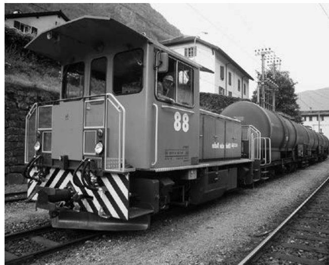
Con il trattore a trazione Diesel i carri merci sono spostati dalla stazione merci alla stazione passeggeri per poi accoppiarli ai treni in transito
