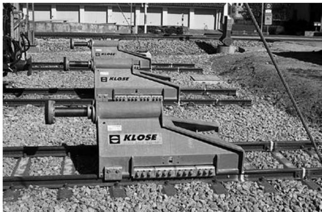
*Il posto con i tre binari di raccordo sul fronte sud è già sfruttato oggi al fine di dare spazio alla ristrutturazione della stazione di Poschiavo. A destra troviamo gli arresti di fine corsa sui tre binari di ricovero (tampon)*
