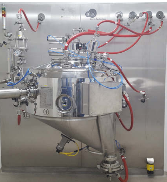
Die Sterilbehälter eignen sich gleichermaßen für Transfer-, Transport- und Mischvorgänge.
