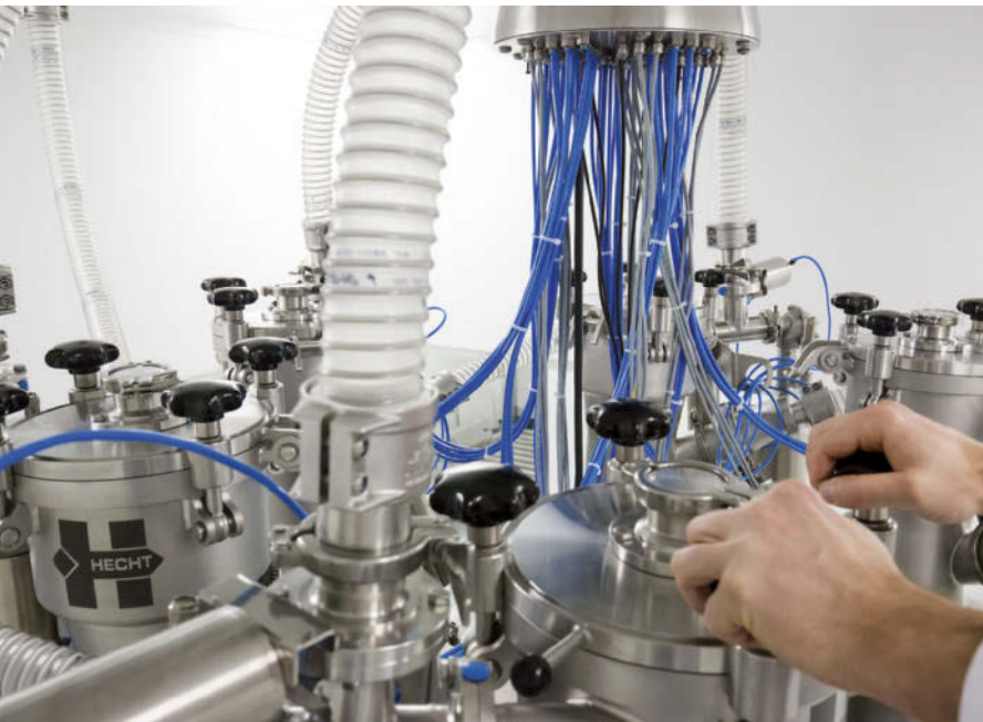
Der staubfreie Produkttransfer geschieht über ein pneumatisches Fördersystem.
