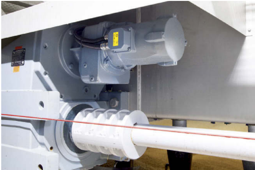
Eine spezielle Lackierung schützt die Antriebe in der vorherrschenden feuchten Atmosphäre.
