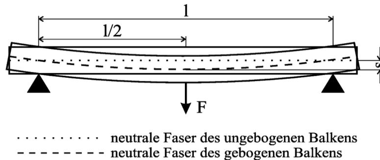
Bild 2: Prinzipielle Anordnung zur Untersuchung der Biegung.
