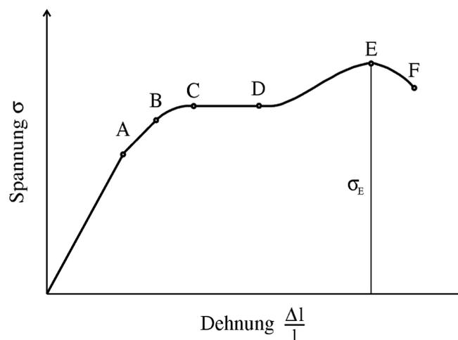
Bild 1: Spannungs-Dehnungs-Diagramm (schematisch).
