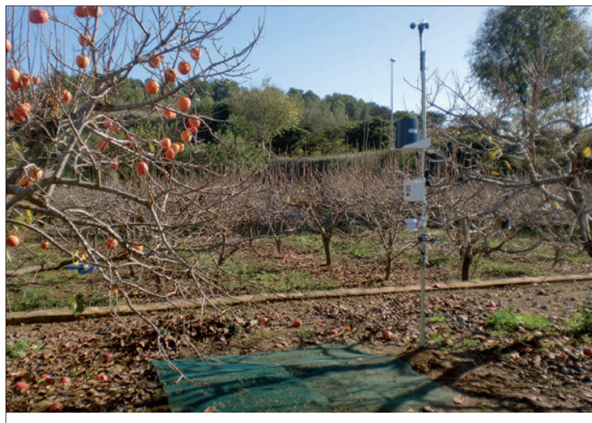
Figura 3. Parcela de caqui afectada por la mancha foliar. Estación meteorológica junto a una malla con hojarasca para el seguimiento de ascosporas de Mycosphaerella nawae .
