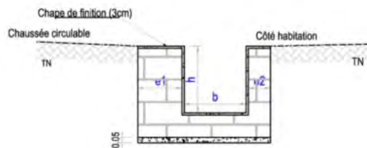
Figure 8. Fossé type rectangulaire (maçonné)
