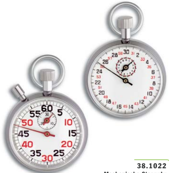
Mechanische Stoppuhr Start/Stopp mit Krone, Rückstellung durch seitlichen Drücker, Zeitunterbrechung möglich, Handaufzug, 13 Steine, Gehäuse Metall verchromt, Auflösung 1/5 Sekunde, inkl. Umhängekordel und Tasche < 30 min Ø 50 x 17 x 64 mm, 98 g, EK
