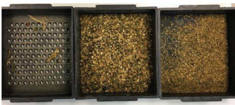
Figura 6. Sistema di valutazione della densità del silomais in fase di utilizzo mediante carotatura di un volume noto e immediata pesata dello stesso. Per riportare il valore alla sostanza secca sarà necessario l'essiccamento del campione fino al raggiungimento di un peso costante, per poi fare il calcolo rispetto al campione di partenza.
