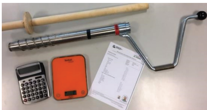
Figura 6. Sistema di valutazione della densità del silomais in fase di utilizzo mediante carotatura di un volume noto e immediata pesata dello stesso. Per riportare il valore alla sostanza secca sarà necessario l'essiccamento del campione fino al raggiungimento di un peso costante, per poi fare il calcolo rispetto al campione di partenza.
