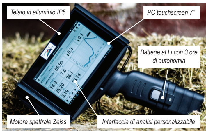
Figura 1 – Lo spettrometro NIR utilizzato in stalla.
