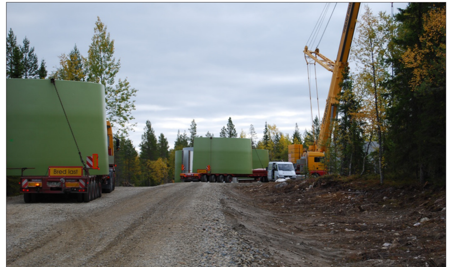
Transporterna är breda och kräver därför breda stabila vägar (foto: Jonas Lundmark).
