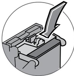
9. Schließen Sie die Tintenzugangsabdeckung. Das System wird die neue Patrone automatisch erkennen und Sie in wenigen Augenblicken wieder zum Startbildschirm zurückbringen. Bringen Sie die Wiegeplattform wieder an, falls Sie sie vorher entfernt haben.
