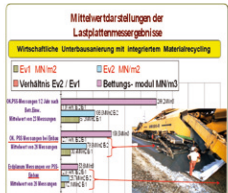
Abb. 14: Übersicht zu Messergebnissen der ÖBB zur Tragfähigkeit und Dichte
