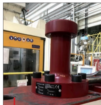
Le plus gros plot de levage permet de soulever des outillages pesant jusqu'à 50 t.
