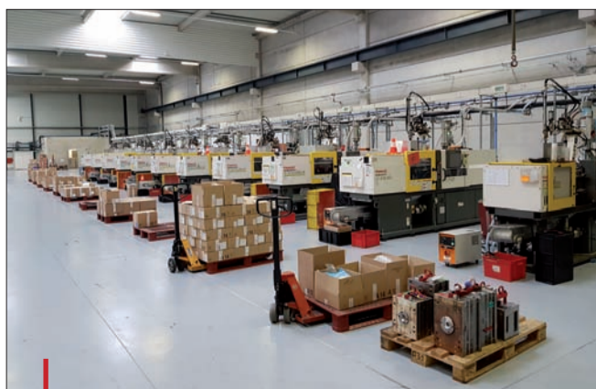
L'atelier d'injection plastique dispose de 28 presses tout-électriques, en grande majorité Fanuc Roboshot.
