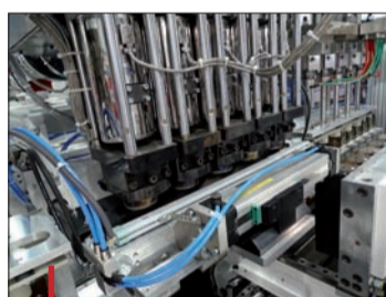
La barre l'électrode ionisante Meech traite les parois de matière sur une machine de soufflage Uniloy.
