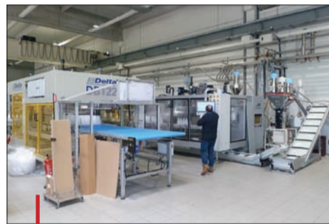
Hesta 700 tout électrique avec mise sous film automatique des produits et palettisation en sortie de soufflage pour atteindre un taux minimum de particules, équivalent à l'ISO 8.
