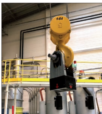
Le système de levage LiftMould s'arrime directement sur le crochet du pont-roulant.
