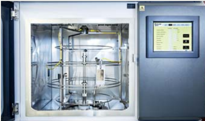
Laborbewitterung von Kunststoffbauteilen.
