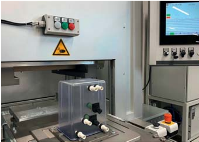
▲ Die Laserschweißstation wurde auf die Anwendung angepasst.
