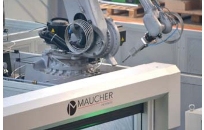
▲ Die Wasserstrahlschneide-Anlage war die erste bei Maucher umgesetzte CNC-Fertigungszelle.
