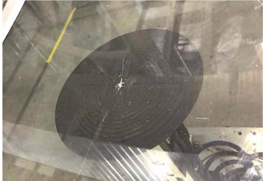
▲ Beim PUR-Umschäumen großer Autoscheiben in Werkzeugen ohne PUR-Flush-Dichtkonzept kommt es schnell zu Glasbruch.
