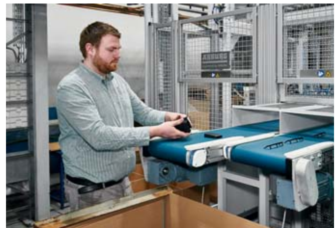
▲ Frank Loschinski begutachtet die „Snap on Cover“. Bei deren Herstellung werden die Teile und Angüsse getrennt auf zwei unterschiedlichen Förderbändern abgelegt.
