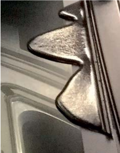
▲ Da große Scheiben mitunter stark gewellt sind, treten oft unerwünschte Überschäumungen auf, die aufwendig von Hand entfernt werden müssen.
