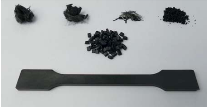
▲ Verschiedene Carbonfaserrezyklate (o.), daraus hergestellte Compounds (M.) und Probekörper (u.).
