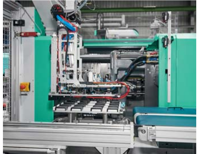
▲ Der Greifer am Multilift Robot-System V mit vertikaler Tauchachse klappt nach der Teileentnahme aus dem Werkzeug um und die B-Achse wird gleichzeitig um 90° gedreht, damit die formnestgetrennte Ablage erfolgen kann.
