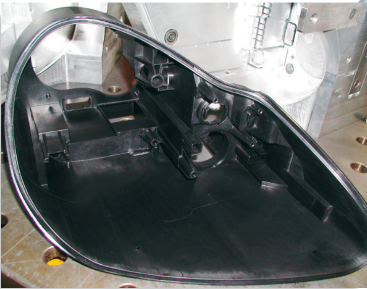
Die Konstruktion für ein Colorado-Scheinwerfergehäuse wurde vor der Produktion an Prototypen aus Originalmaterial geprüft und optimiert.
