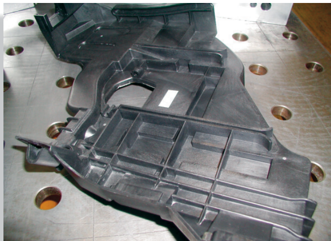
SPM-Formwerkzeuge stehen schon nach kurzer Zeit zur Verfügung und liefern serienidentische Kunststoffteile aus Originalmaterial. (Bilder: protoform)
