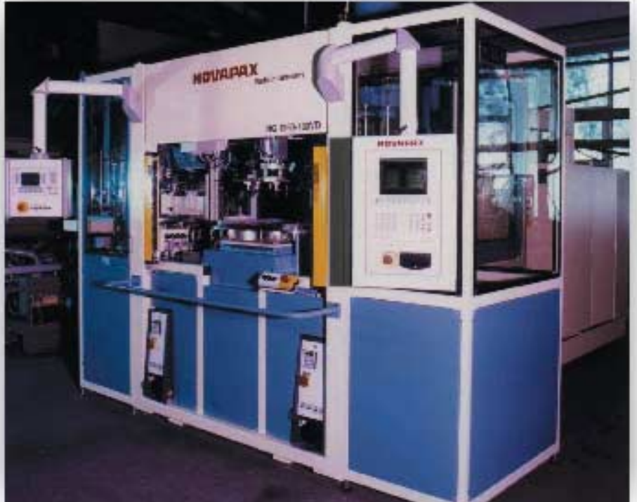
Der Anbieter hat unterschiedliche Maschinenkonzepte mit vertikalen Schließeinheiten und Mehrstationen-Drehtellern im Programm; für die Bedienung der Maschine und das automatische Zuführen von Einlegeteilen steht jeweils ein Bedienterminal zur Verfügung
