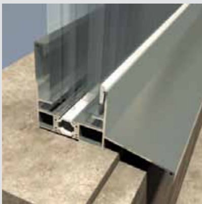
Oberes Profil Detail der vertikalen Verglasung und oberer Ausdehnungsspielraum
