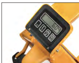
Gabelhubwagen mit Waage
