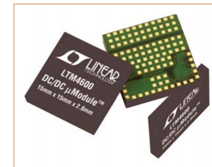
图3. 具有金涂层的衬垫使得符合RoHS标准的LTM4600能够采用含铅和无铅焊膏来进行表面贴装。
