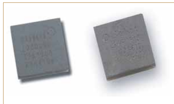
图 1. 典型的分立器件。典型的 FBAR 滤波器 (左) 和采用 E-pHEMT 有源裸片的放大器 (右)。
