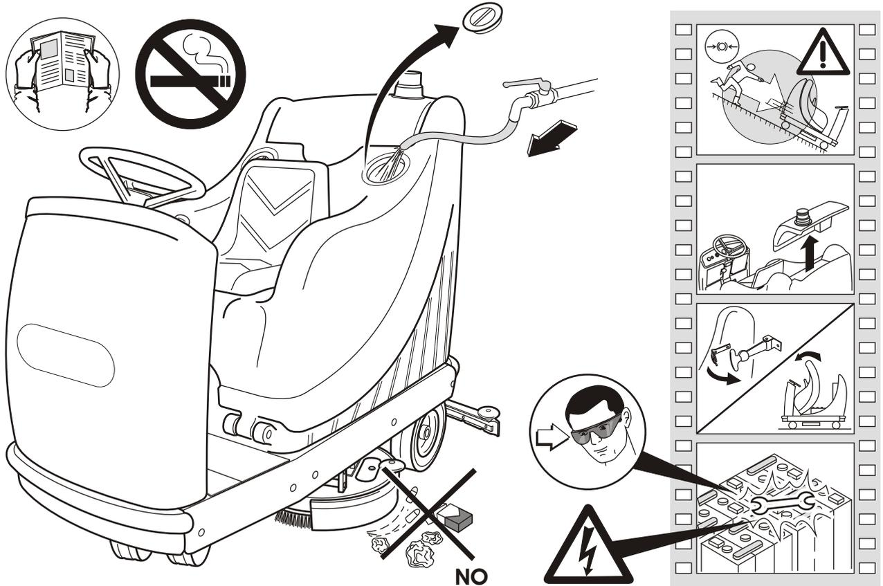
Quando si lavora intorno alle batterie usare occhiali e vestiti protettivi. Togliersi eventuali oggetti di metallo. Non appoggiare utensili di metallo o attrezzi di qualsiasi genere sulle batterie. La ricarica delle batterie genera gas esplosivi.
