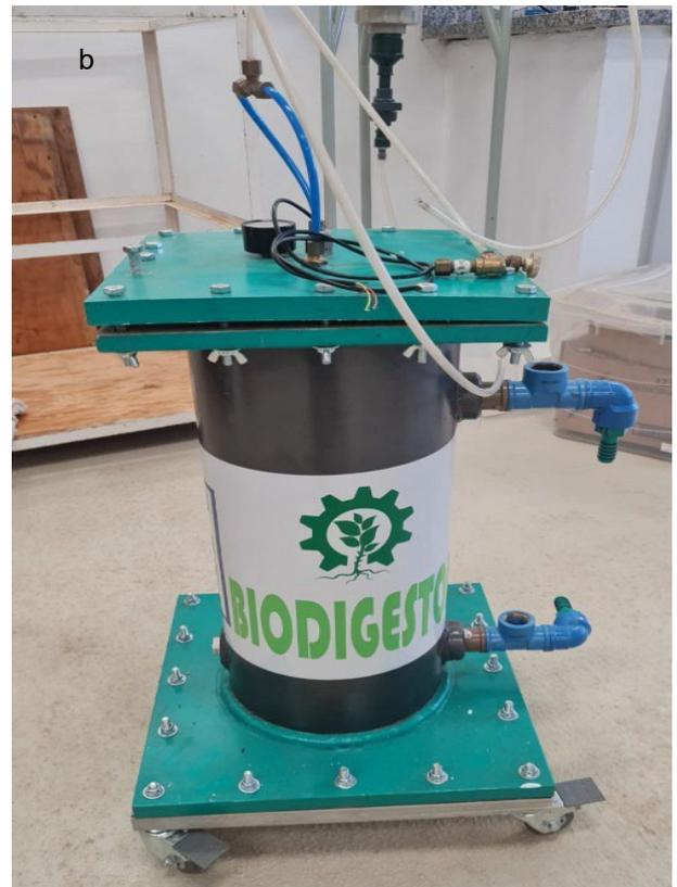
Figura 4 - Representação da construção do biodigestor.
