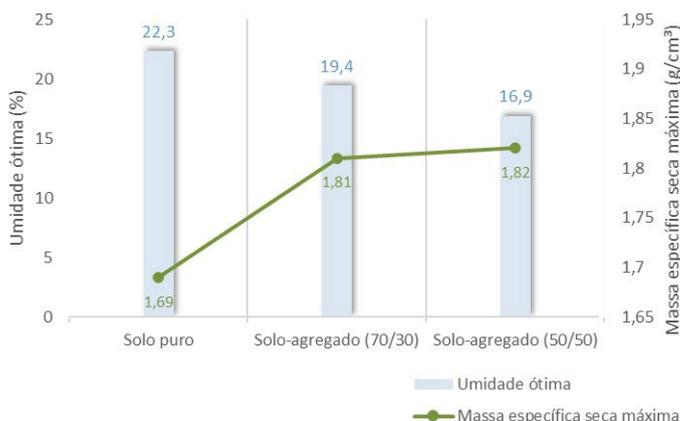
**Figura 2** - Determinação da umidade ótima e massa específica seca máxima a partir de ensaio de compactação Proctor para os três teores da mistura solo-agregado
