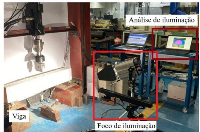
**Figura 2** – Configuração da coleta de imagens.
