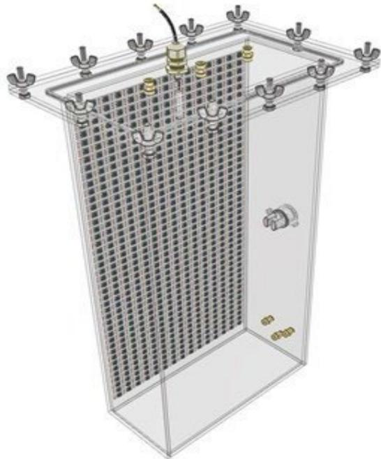
Figura 3 - Representação da construção do fotobiorreator.
