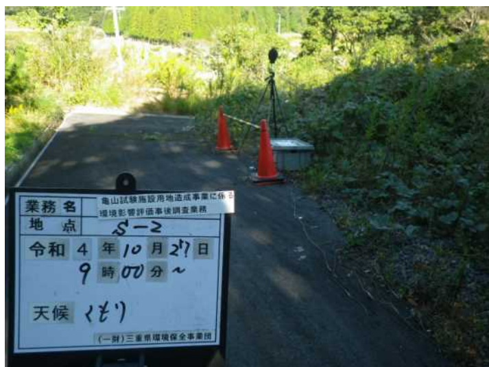
写真①-5 騒音・振動調査状況 (S-2：令和4年10月27日)
