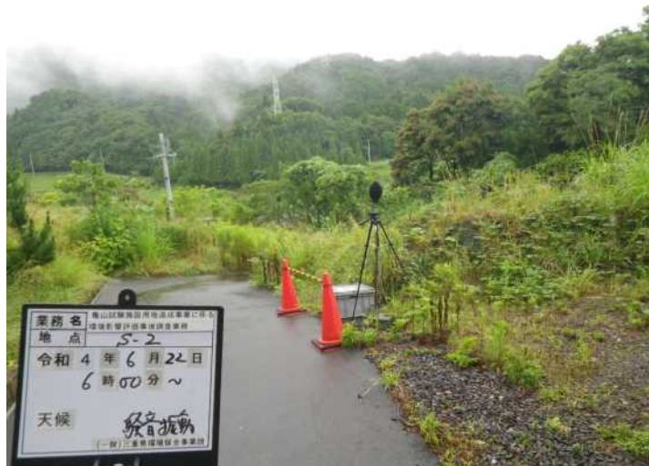
写真①-2 騒音・振動調査状況 (S-2：令和4年6月22日)
