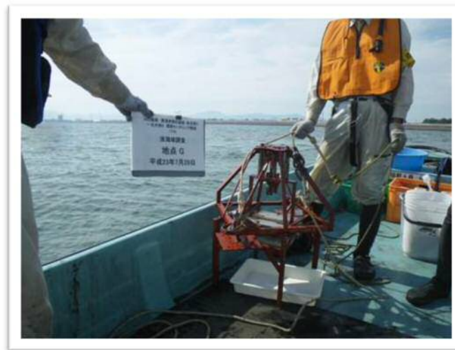
写真 3.6-4 浅海域における定量調査の実施状況（小型スミスマッキンタイヤー投入）
