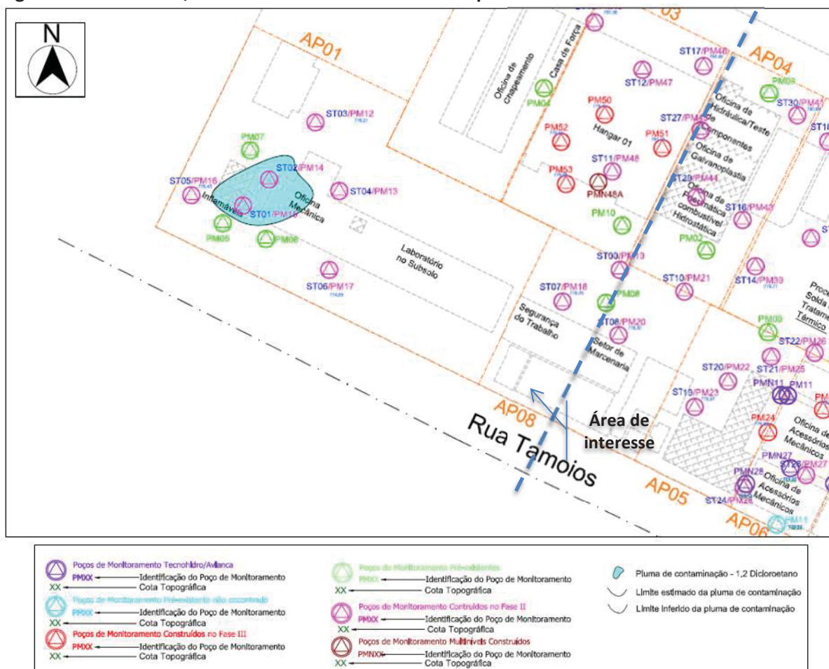
Figura 10. Pluma de 1,2-dicloroetano no nível raso do aquífero - 2014
