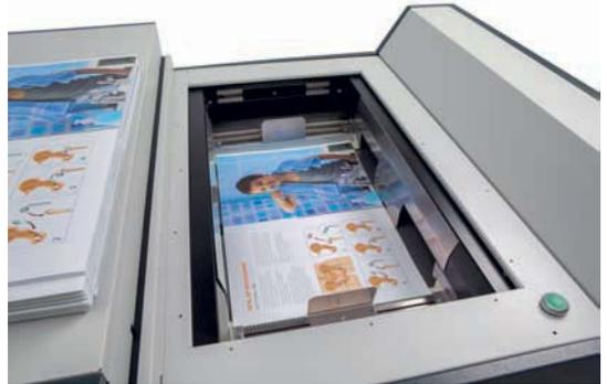
*Einlegen eines digital gedruckten, bereits vollständigen Satzes in die Handanlage der Broschürenfertigung.*
