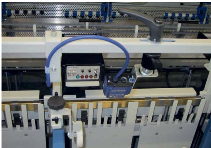
**Stationsweise Fehl- und Doppelbogenerkennung mittels intelligentem Kamerascanner: MKW 2016-ID1.**
