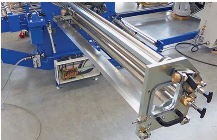
*Serienmäßig bei der MBO T1420P: die patentierte Messerwellenkassette.*
