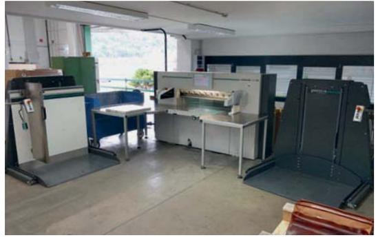
**Die beiden Perfecta-Stapellifte ermöglichen durch automatisches Anheben und Absenken der Paletten/ Stapel eine Minimierung des Kraftaufwandes.**
