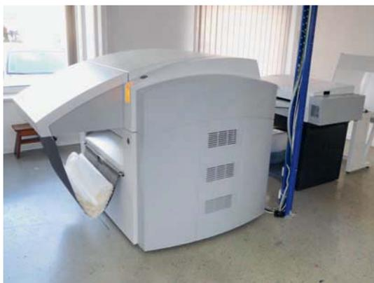
*Der Heidelberg Supra A75 CtP-Belichter als Vollautomat mit Wascheinheit für chemiefreie Thermalplatten ist bei Schlutius seit Juni 2017 inklusive dem Prinect-Workflow störungsfrei in Betrieb.*
