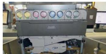
**Die geöffnete Ricoh Pro C9200 zeigt viel stabiles Metall im Maschinenbau und eine doppelte Tonerkartuschen-Belegung der Farbstationen.**
