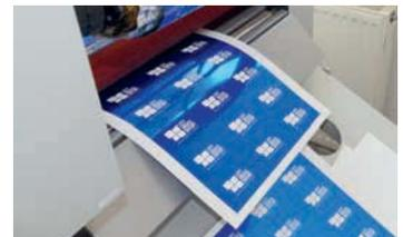
*Sleeking: Mit Toner bedruckte Druckbögen werden der Vivid Matrix MX-530DP zugeführt, unter Druck und Hitze mit einer Metallicfolie verbunden und ergeben dort, wo der Toner haftete, feinst veredelte Metallic-Flächen.*
