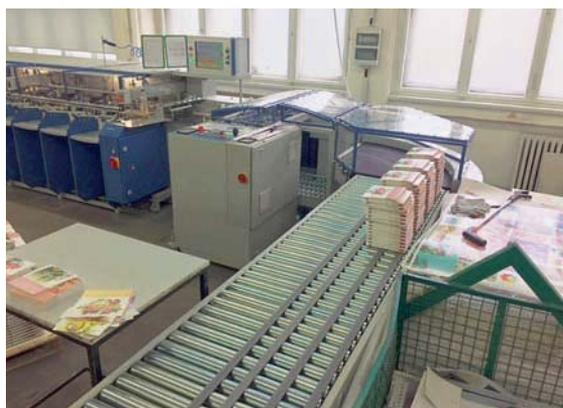
**Passt optimal: die Nonstop-Auslage MKW Rapid TD-3 im 90-Grad-Winkel zur UT-32.**
