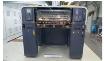
*Seit Ende Juli 2018 bei Möller im Einsatz: die Roland 705 L VV Evolution von manroland sheetfed, ausgerüstet mit InlineLackwerk für Dispersions- und UV-Lackveredelungen und mit InlineColorPilot für schnelle Messungen.*
