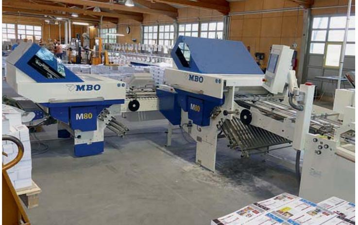
*Die MBO-Falzmaschine M80 wurde von Baumann im Juli 2018 bei der MR-Druckverarbeitung eingebracht. Als Taschenfalzmaschine 6/6/4 ist die M80 bei MR mit dem Rundstapelanleger R80 und der Auslage A70 ausgerüstet.*
