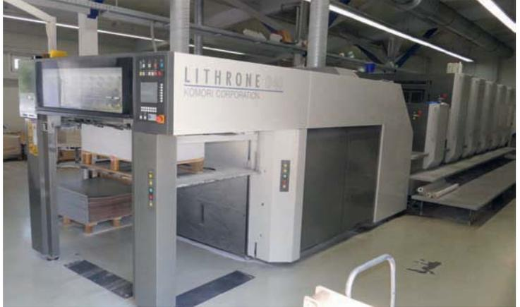
**Nach 75 Millionen Drucken steht fest: Die Fünffarben-Komori Lithrone G40 plus Lack konnte bei Rapp-Druck drei Mittelformat-Maschinen ersetzen und hatte in viereinhalb Jahren einen sehr geringen Wartungsaufwand.**
