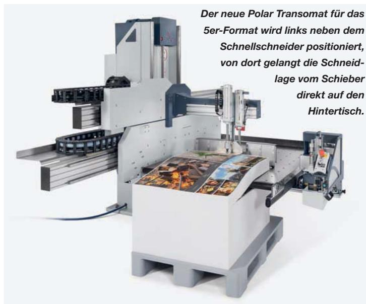
**Der neue Polar Transomat für das 5er-Format wird links neben dem Schnellschneider positioniert, von dort gelangt die Schneid-lage vom Schieber direkt auf den Hintertisch.**
