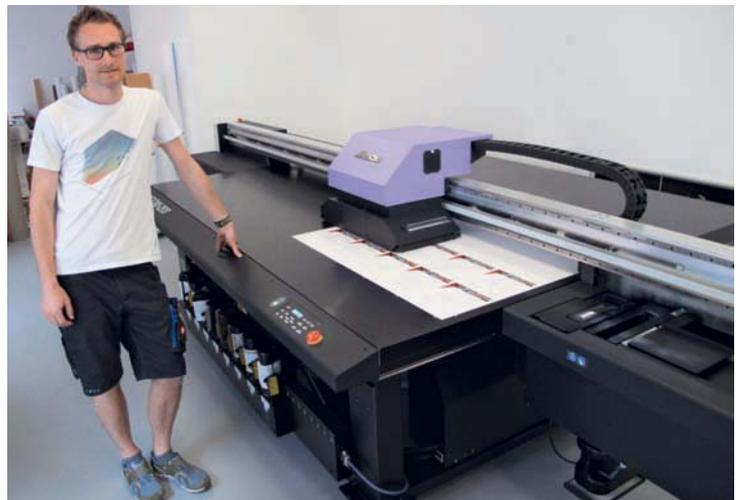
*Besondere Produkte erfordern die entsprechende Technologie. Das neue LED-UV-Flachbettdrucksystem eröffnet gerade im Segment Werbedruck ganz neue Möglichkeiten, hier mit Medienoperator Tim Friedrich.*
