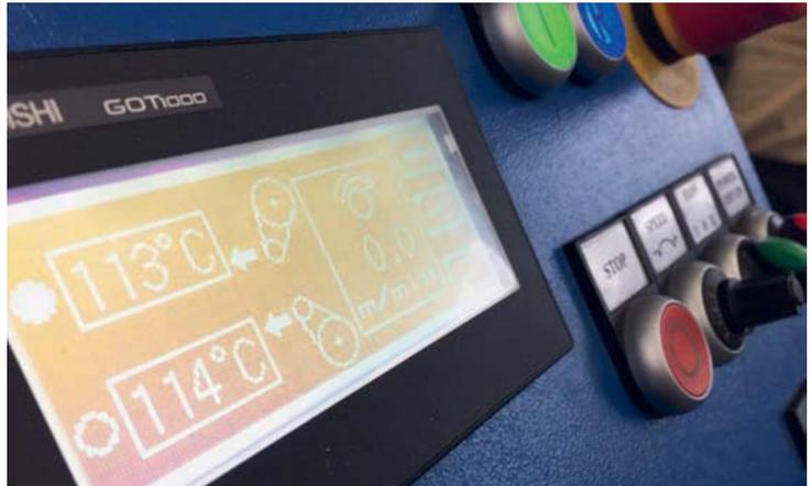
**Die separate Temperaturregelung der oberen und unteren Heizwalze erlaubt die Verarbeitung unterschiedlichster Materialien.**
