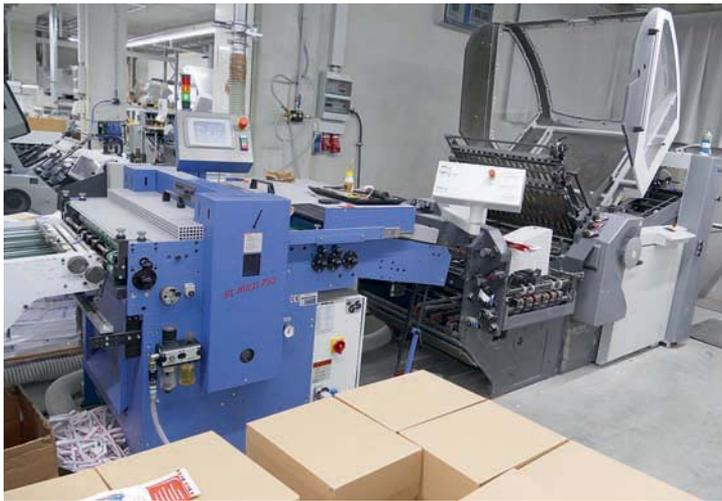
**Neueste Investition für die Blueprint-Weiterverarbeitung: die mit einer Falzmaschine inline arbeitende Bograma-Hubstanzmaschine BS Multi 750.**
