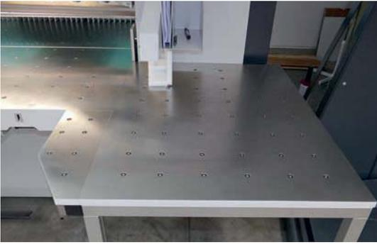
**Vergrößerte Seitentische bieten mehr Platz und Raum für das Arbeiten am Schnellschneider. Dies ist vor allem bei Ein- und Auslagerungsprozessen vorteilhaft.**
