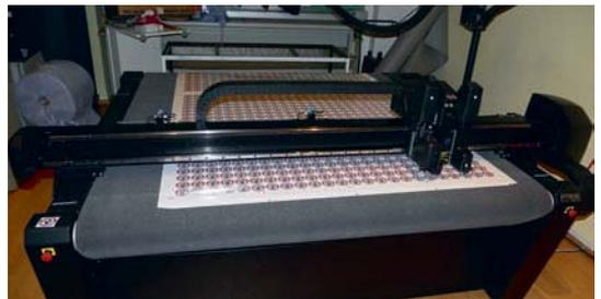
*Ein Flachbett-Schneideplotter bei Arte Werbung. Er ermöglicht die kleinteilige Produktion aus Großformat-Rollenmedien wie die bei der Colorado 1640.*
