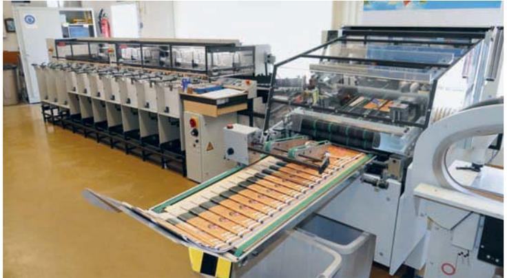
*Mit zehn Stationen und anschließender Broschürenfertigung sorgt das Zusammentragen an der Theisen & Bonitz-Anlage für eine sichere Produktion.*
