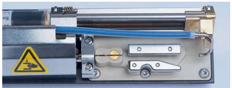
**Der hauchdünne Tintenstrahl ist mit dem Auge kaum zu erkennen. Er besteht aus tausenden feinsten Tropfen, die beim Drucken auf die Produktoberfläche fliegen – abgelenkt durch ein Hochspannungsfeld.**
