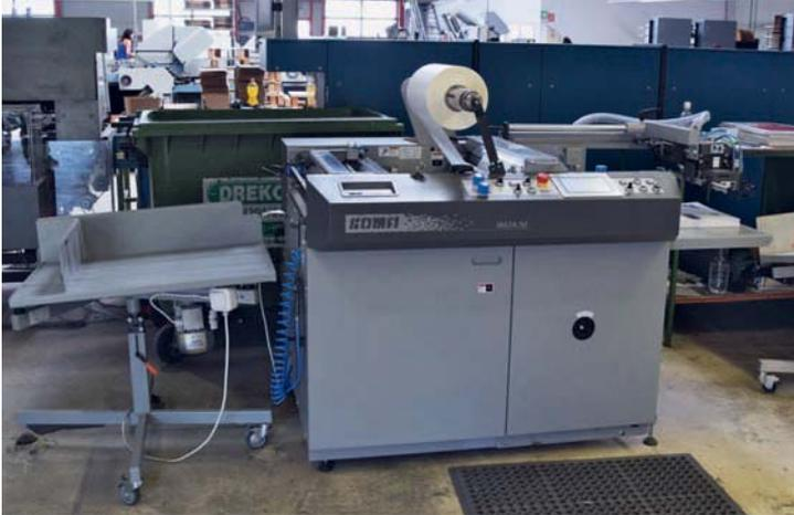
*Das Kaschiersystem FKS/Komfi Delta 52 im B2-Format verarbeitet Grammaturen von 115 bis 600 g/m<sup>2</sup> mit einer Geschwindigkeit bis zu 35 m/min.*
