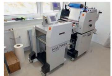
*Die Vivid Matrix MX-530DP von dmsDigital dient bei City Druck Erfurt dem beidseitigen Laminieren und Sleeking. Rasant schnell wird die Matrix durch einfaches Koppeln mit dem vollautomatischen Anleger »OmniFlow Feeder«.*
