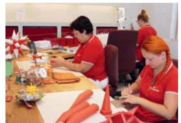
*Die vom Perfecta-Schnellschneider geschnittenen Papier- oder Karton-Streifen werden per Exzenterpresse zu Einzelteilen gestanzt und geformt und anschließend – hier in der Schauwerkstatt – manuell zusammengebaut/-geklebt.*
