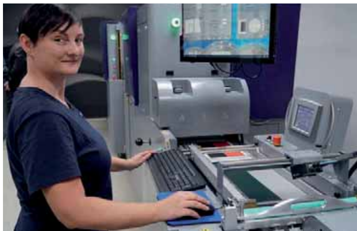
Die JetVarnish 3DS, hier bedient von Nicole Stöbe, verfügt über ein Scanner-System für eine hohe Passgenauigkeit. Es vergleicht die Bogenlage mit einer Referenzdatei und passt das Druckbild entsprechend an.
