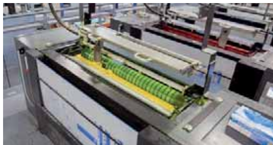
Cron/Blackwood-UV-Druckplatte im automatischen Plattenwechsler einer Achtfarben-Speedmaster XL106.
