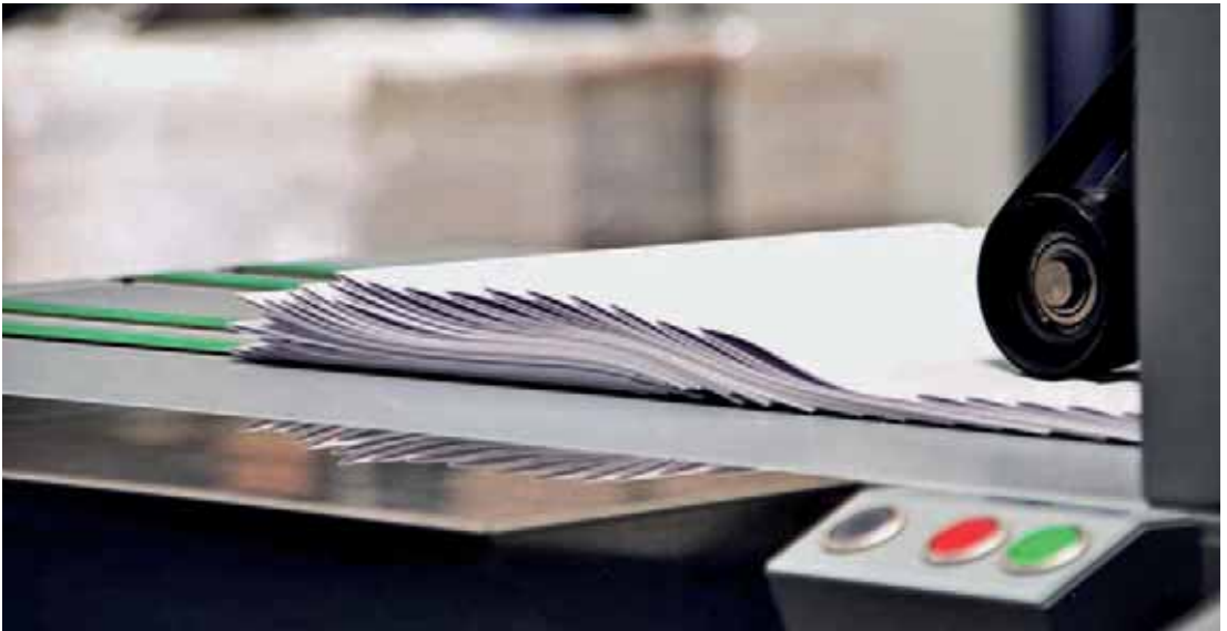
Digital gedruckt, erledigt der StitchLiner Mark III vollautomatisch sämtliche Arbeitsgänge zur Herstellung rückstichgehefteter Broschüren.
