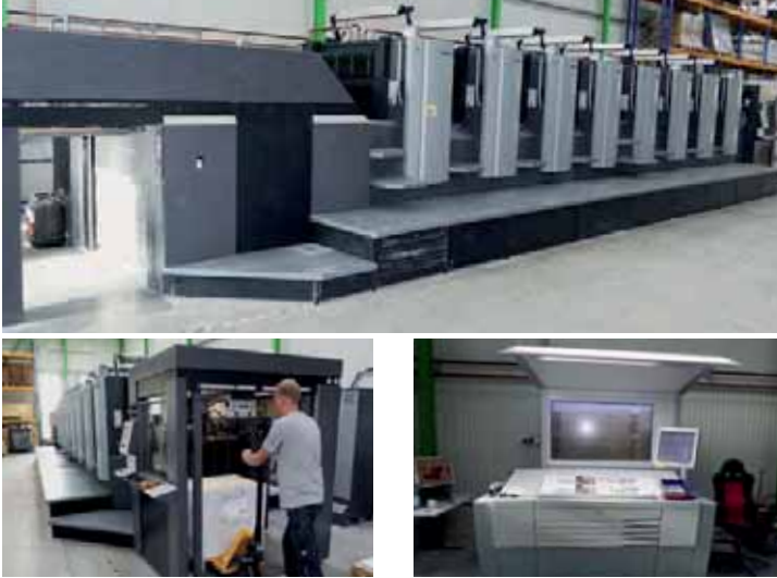
Eine ausgestattete Heidelberg Speedmaster SX 102-8-P5 aus dem Jahr 2013, komplett mit Prinect Press Center und InpressControl sowie Auto-Plate Pro, nahm im August 2019 bei Lindhauer die Produktion auf.
