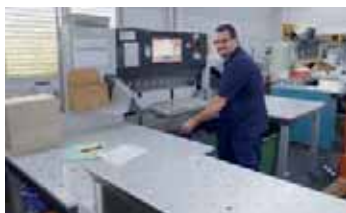
Für sauberen Beschnitt sorgt hier Buchbindereileiter Harald Groß am 2018 von Heidelberg eingebrachten Schnellschneider Polar N 115 Plus.
