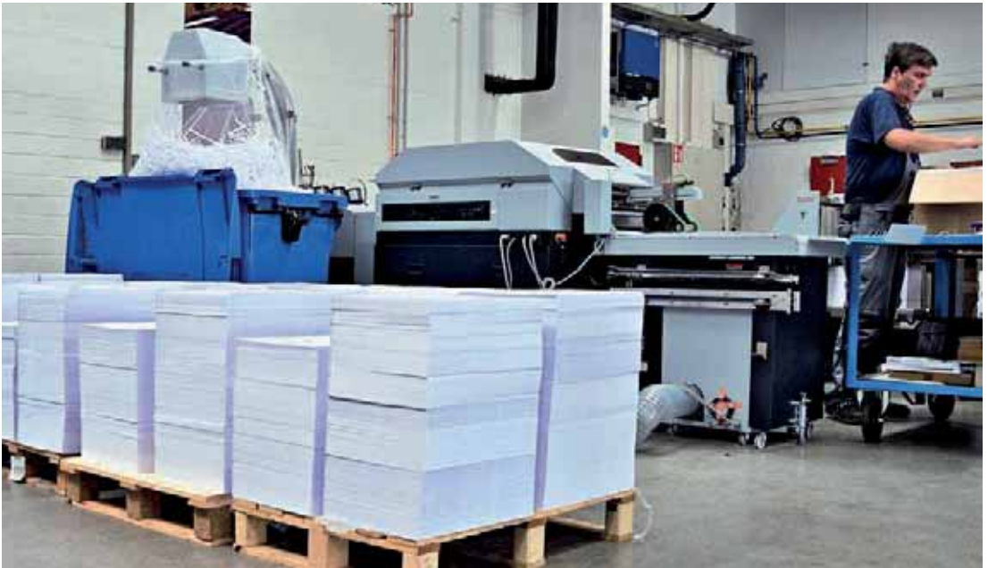
Idealer Partner für den Digitaldruck: variable Produktion rückstichgehefteter Broschüren mit dem StitchLiner Mark III.
