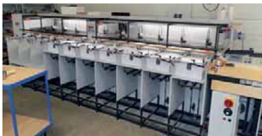
Der Austausch einer 18 Jahre alten Theisen & Bonitz-Anlage gegen eine neue Zusammentragmaschine tb sprint B 310 SP (I.) mit Heft-Falz-Schneid-Maschine tb B304 QSM fand bei Max Siemen durch Helmar Schmidt im April statt.
