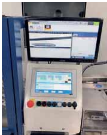
Die Steuerung und das Überwachungssystem per Kamera.
