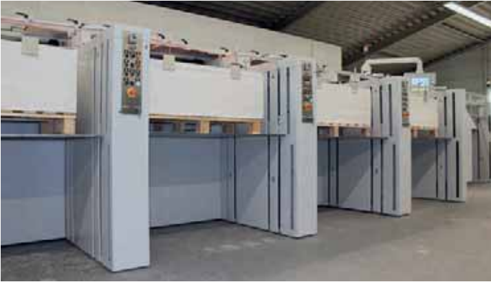
Die Stationen der MKW Gigant für Bogenformate bis 145 x 106 cm können jeweils Stapel bis 1,40 m Höhe und zwei Tonnen Gewicht verarbeiten.
