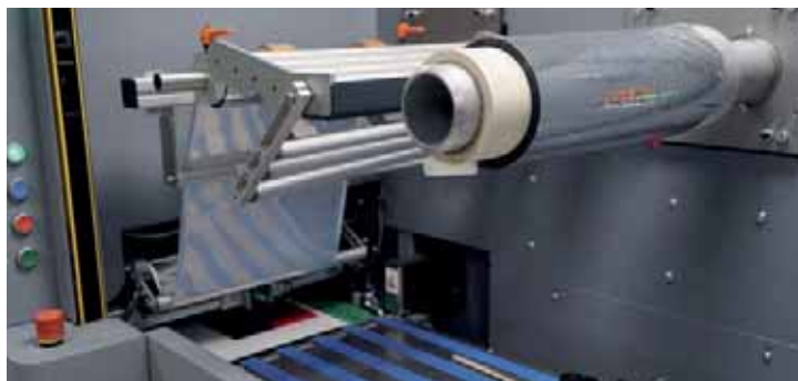
Das iFoil-S-Modul erlaubt die Verwendung aller handelsüblichen Folien.
