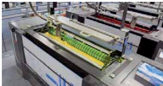
Cron/Blackwood-UV-Druckplatte im automatischen Plattenwechsler einer Achtfarben-Speedmaster XL106.
