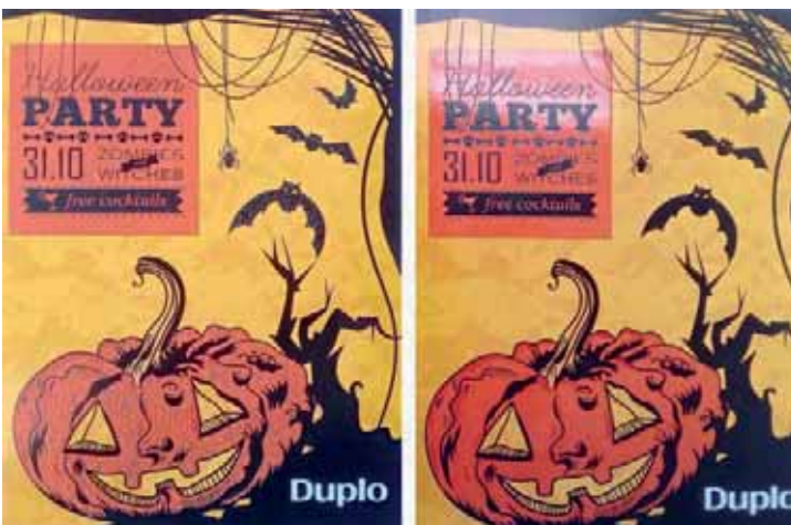
Mit dem gleichen Lack zum gewünschten Ergebnis, egal welcher Druck (links ohne, rechts mit Corona-Einheit).
