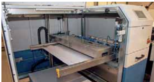
Paletten-Autoloader für die vollautomatische Verarbeitung von 1.500 Druckplatten á 0,30 mm im 3B-Format.
