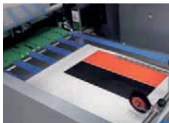
Das Sujet wird per Inkjet als klebrieger Lack auf den Bogen gedruckt ...
