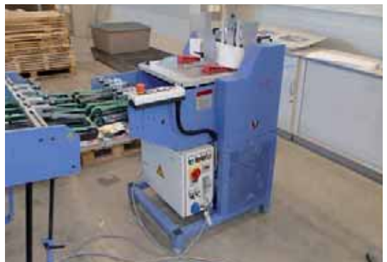
Der Bograma Hochleistungs-Trommelanleger TA 20 lässt mit seiner Leistung von bis zu 20.000 Takten pro Stunde den Offline-Betrieb der Hubstanzmaschine zu.
