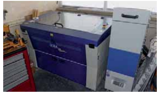
Der CO 2 -Laser von GCC dient Lorch zum Gravieren und Stanzen. Damit hat man sich auch eine Sonderstellung beim Veredeln von Druckprodukten erarbeitet.
