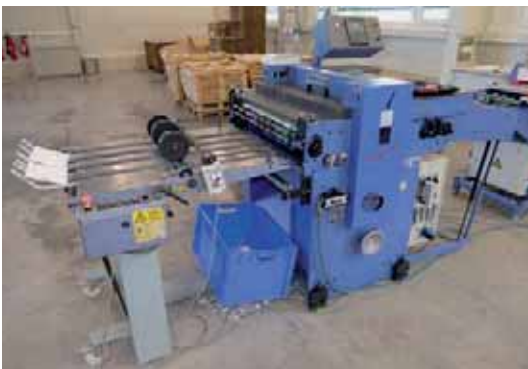
Die Hubstanzmaschine Bograma BS Multi 750 S bei oeding ist ein universell einsetzbares Modell für den mittleren Leistungsbereich bis 10.500 Takte pro Stunde.
