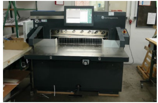
Teil 3 des Steuber-Pakets: der Schnellschneider baumannperfecta 80 mit ServoDrive (für die exakte Positionierung des Schneidguts) und geschlossenem Schneidtisch.
