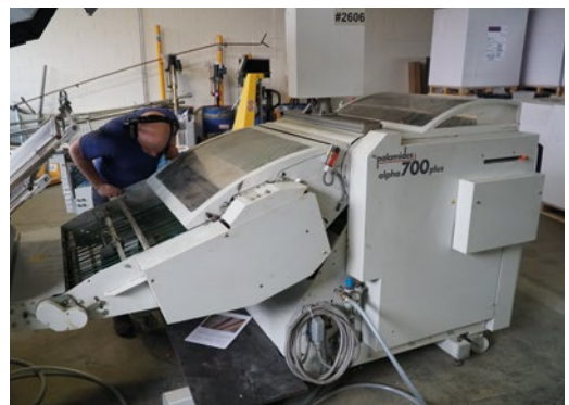
Die MBO T960 ist mit einer Stapelauslage palamidés alpha 700 (Format: max. 760 x 330 mm) ausgestattet.
