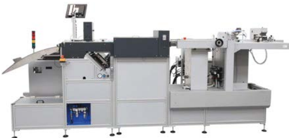
Vollautomatisches Buchbindesystem fastBlock – links in der Variante zur Bogenverarbeitung, rechts von der Rolle.
