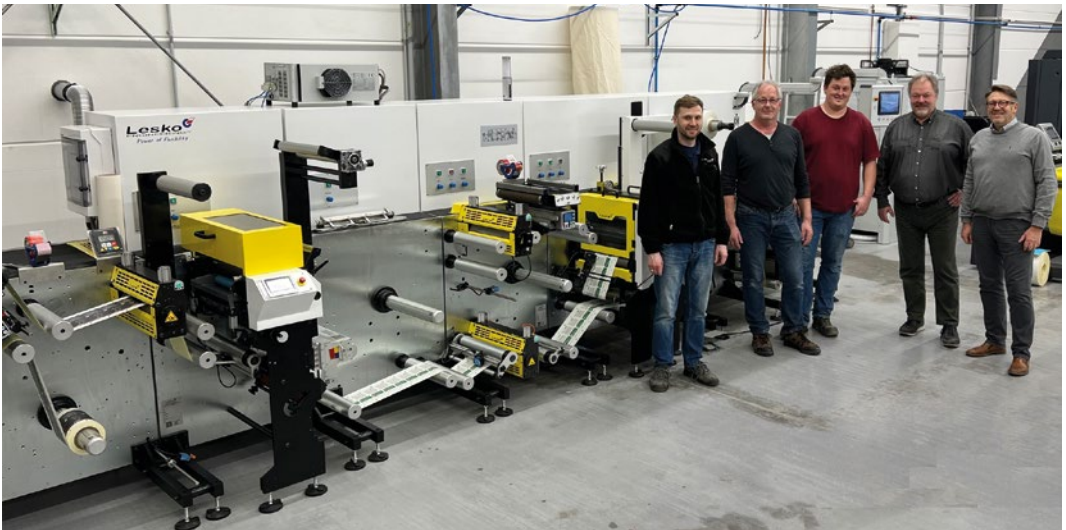
Gruppenbild mit Maschine nach der gelungenen Installation der komplexen Konvertier- und Finishing-Maschine Lesko CL 380 mit Flexowerk, Laminiereinheit und Stanzstation (rotativ/semirotativ) bei der Druckerei Heinen GmbH in Bad Münstereifel (v.l.): Michal Karbownik, Service Manager von Lesko Engineering, aus der Inhaberfamilie Jürgen Heinen, Lukas Heinen und Jochem Heinen sowie der Geschäftsführer der Grafische Systeme GmbH, Holger Grundmann.
