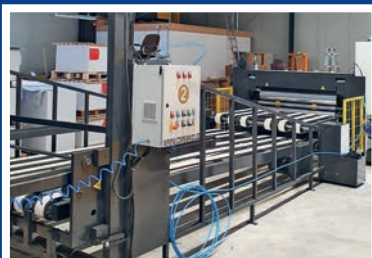
Flexo Druckmaschine Altinisik Bedrucken von Karton und Wellpappe
