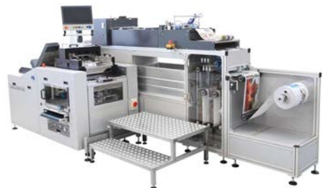
Vollautomatisches Buchbindesystem fastBlock – links in der Variante zur Bogenverarbeitung, rechts von der Rolle.
