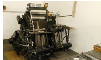
Über Jahrzehnte als Stanz- und Veredelungsmaschine hoch geschätzt: der Tiegel. Bei NoWe steht er noch.
