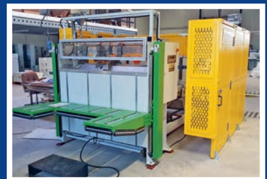
Flexo Druckmaschine Altinisik Bedrucken von Karton und Wellpappe
