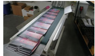
Schnell ist die Auslage der WIL420 SP von JBI mit komplett produzierten Kalendern gefüllt.
