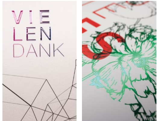
Partieller haptischer Drucklack (l.) und Folien-Veredelung (r.).
