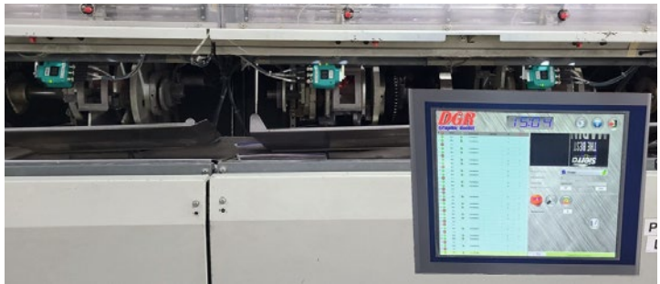
Das hochauflösende kamerabasierte DGR OCS-System wurde entwickelt, um neue Maßstäbe beim Vergleich von Druckbildern und Barcodes zu setzen und damit alle Anforderungen in der Druckindustrie abzudecken. Die an die Vorstufe angebotenen Prüfsysteme unterstützen auch speziell entwickelte und kodierte Barcodes wie zum Beispiel ASIR-Marken Code128 oder WST 2i5Codes.
