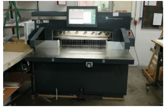
Teil 3 des Steuber-Pakets: der Schnellschneider baumannperfecta 80 mit ServoDrive (für die exakte Positionierung des Schneidguts) und geschlossenem Schneidtisch.
