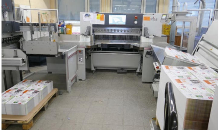
Das Polar CuttingSystem 200 beim AC Medienhaus (seit September 2021): Polar-Stapellift LW, Rüttler RA, Schnellschneider N137 Autotrim und Transomat E.
