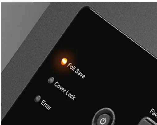
Der HAK-100 verfügt über einen Folienspar-Modus, der es ermöglicht, die Folie nur partiell statt über die volle Fläche aufzutragen.
