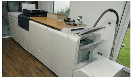
Basis für den Digitaldruck ist eine Xerox Versant 180 mit automatischer Farbkalibrierung und Ultra-HD-Auflösung.
