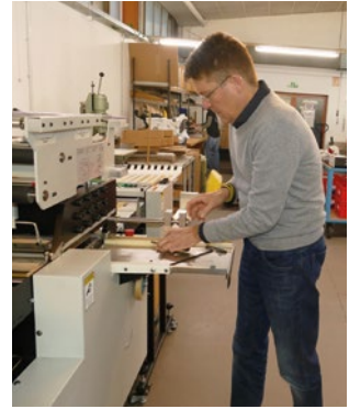
Michael Jellinghaus führt den schnellen Stanzwerkzeug-Wechsel an der NSF Excel vor. Die kurzen Rüstzeiten ermöglichen es, viele Kleinauflagen aus dem Digitaldruck auf unterschiedlichste Art und Weise zu bearbeiten.
