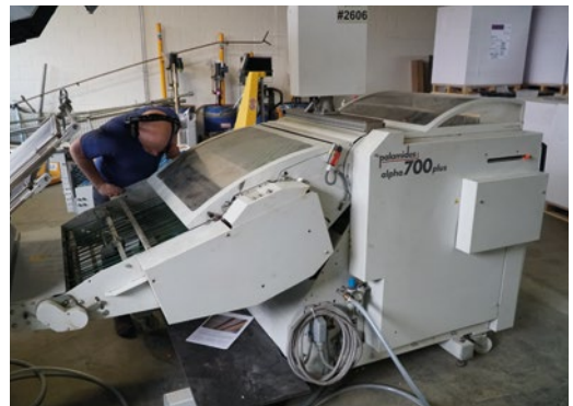
Die MBO T960 ist mit einer Stapelauslage palamidess alpha 700 (Format: max. 760 x 330 mm) ausgestattet.
