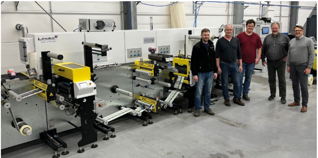
Gruppenbild mit Maschine nach der gelungenen Installation der komplexen Konvertier- und Finishing-Maschine Lesko CL 380 mit Flexowerk, Laminiereinheit und Stanzstation (rotativ/semirotativ) bei der Druckerei Heinen GmbH in Bad Münsteriefel (v.l.): Michal Karbownik, Service Manager von Lesko Engineering, aus der Inhaberfamilie Jürgen Heinen, Lukas Heinen und Jochem Heinen sowie der Geschäftsführer der Grafische Systeme GmbH, Holger Grundmann.
