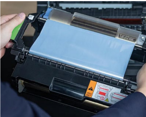
Dank des praktischen Kassettensystems können die Folien innerhalb weniger Minuten mit nur wenigen Handgriffen ausgetauscht werden.
