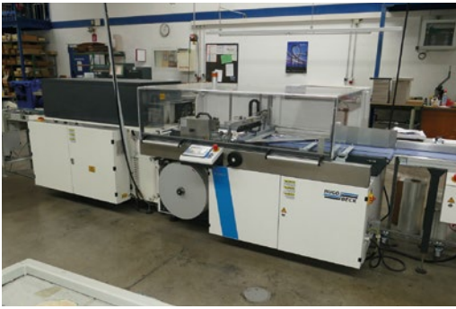
Teil 2 des Steuber-Pakets: der Einschweißautomat von Hugo Beck mit taktender Schlauchbeutelmaschine und Schrumpftunnel für ein perfektes Finish.
