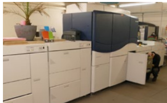
Mit der Xerox iGen 150 ist bei NoWe Druck auch der Verpackungsdruck bis zu 0,5 mm Substratstärke möglich.
