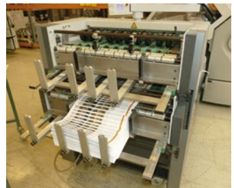
Der Twinstacker dient der markierungsfreien Auslage mit bis zu zwei Nutzen und einer bedienerfreundlichen, ergonomischen Abnahme.
