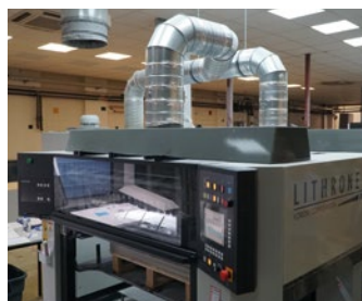
Die verbesserte Puderabsaugung und die neue Auslage gehören zu den Features der Advance-Baureihe.
