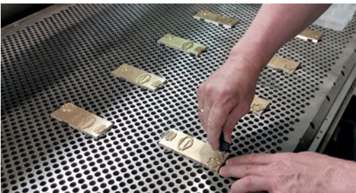
Prägestempel-Positionierung auf berechnete Zielposition.
