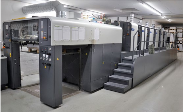
Die perfekte Maschine für den Perfektionisten: Die Inline-Farbmessung der neuen Manroland R706 Evolution Elite lässt nichts durchgehen – eine Sicherheit, die vor allem bei hohen Auflagen unbezahlbar ist.
