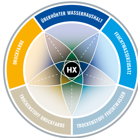
Abbildung 2: Die Interaktion von fünf schwer zu steuernden Einflussfaktoren verursacht die chemischen Angriffe auf den Walzenbezug. Der Spezialwerkstoff Werograph-HX kann hier Abhilfe schaffen.
