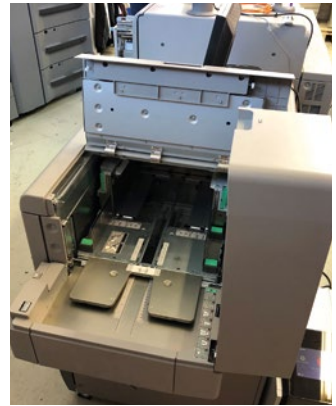
Der optionale Vakuum-Einzug für den automatischen Duplexdruck von Bannermedien mit bis zu 700 mm Länge (Simplex bis 1.260 mm).
