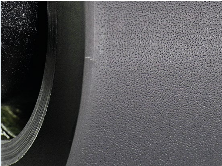
Abbildung 1: „Orangenhaut“-Effekt: Chemische Angriffe, beispielsweise durch Farben und Feuchtmittelzusätze, können zu einer solchen Oberflächenstruktur auf der Walze führen – schlecht fürs Druckergebnis.
