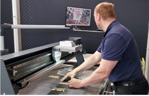
Positioniersystem Kama CPX 106 für Flachbettprägemaschinen mit Multilayer-Screen zur Schnellpositionierung.
