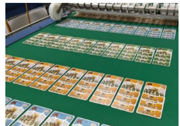
Die rotative Stanzmaschine BSR 550 Servo bildet die Basis für eine Spielkartenproduktionsanlage, die Bograma anbietet (automatisches Stanzen, Zusammentragen und Stapeln kompletter Kartendecks).
