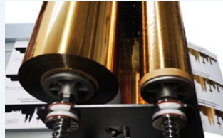
Laminiervollautomat Magnopro LAM-350 XP mit serienmäßiger Sleeking-Einrichtung zur Veredelung von tonerbasierten Digitaldrucken.
