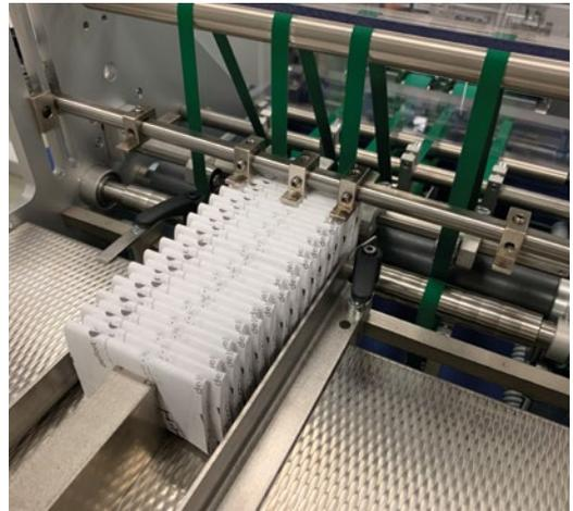
In Reih und Glied: die Packungsbeilagen eines Test-Jobs in der Auslage der H+H-Falzlinie M9.
