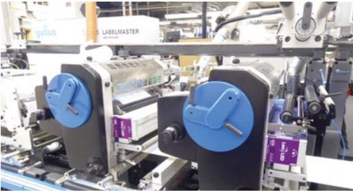
Für seine Labelmaster-Druckmaschinenplattform hat Gallus auch ein neues Arretierungssystem entwickelt. Die Druckwerke lassen sich so schneller wechseln.
