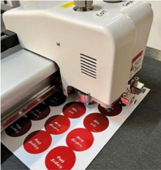
Kiss-Cut-Aufkleber waren die ersten Produktionen bei Lippert mit der neuen Magnopro i-Cut 7550 Plus, die unter anderem über einen Saugluft-Bogenanleger, ein Saugband, ein CCD-Kamerasystem, einen Barcode- und QR Code-Leser sowie ein oszillierendes Messer (EOT) für Material bis zu 6 mm Stärke verfügt.
