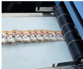
Die OXO Multiskill von binderhaus bewältigt 250 g/m<sup>2</sup>-Bögen in DIN A3+ (Bild links) ebenso wie Kleinformaten wie die 400 g/m<sup>2</sup>-Postkarten im Bild rechts, die von DIN A6 auf DIN A7 gefalzt wurden.
