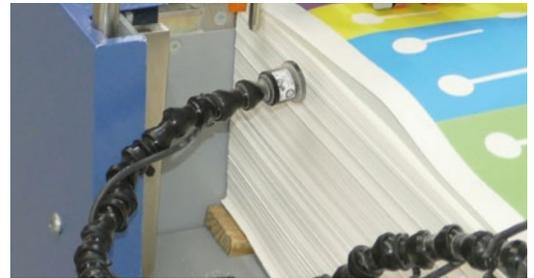
Die nachgerüstete Antistatik-Blasluftereinrichtung ermöglicht das präzise Vereinzeln der zu bearbeitenden Bögen, auch wenn es sich um Kunststoffmaterial handelt.
