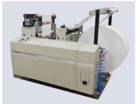
Highend-Abroller RFU 600 (600 mm breit) mit Splice-Tisch, Decurlingeinheit und elektrischem Rollenlift.
