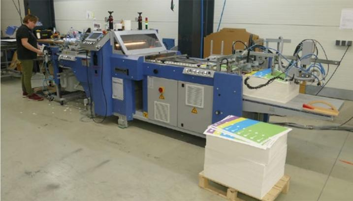
Die Bograma BS Rotary 550 Servo verarbeitet bei Sauter Druck seit rund fünf Jahren Bogen zwischen 210 x 210 mm und 550 x 750 mm mit Produktstärken von bis zu 0,5 mm sowie mit einer maximalen Leistung von bis zu 12.000 Bg./h.
