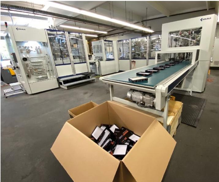
Die neue vollautomatische Kaschiermaschine Box Line Wrapper BLW 200 von Kolbus bei der Stülpedeckel-Fertigung bei copy-druck in Hamburg.
