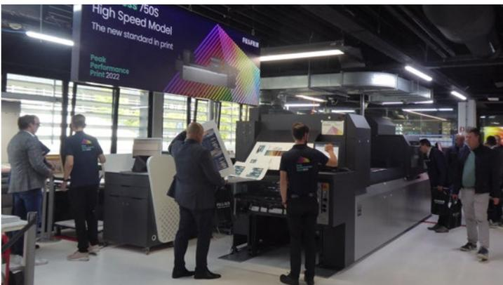
Die Jet Press 750S High Speed war einer der Besuchermagneten bei einem Kundenevent von Fujifilm in Brüssel. Das Inkjetsystem druckt bis 5.400 B2-Bogen pro Stunde und ist damit eine echte Alternative zu Bogenoffsetdruckmaschinen.
