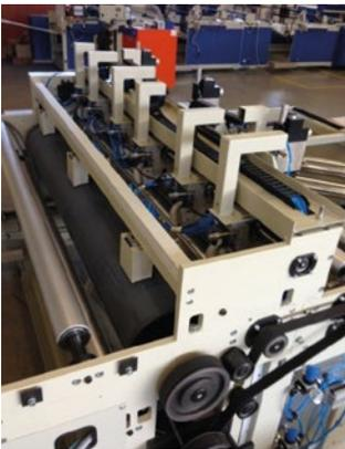
Anwendungsbeispiel einer mit sechs Längsperforationen ausgerüsteten Station.
