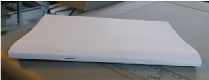
Der 200-Seiten-Test mit der Plockmatic BM5050S hat funktioniert. Von A6 über A4-quer, von 99 x 210- bis hin zu 320 x 310 mm-Broschüren ist alles möglich.
