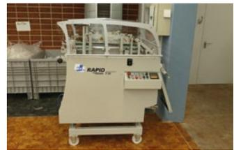
Das schnelle Zusammentragen oder die Komplettproduktion von gehefteten Broschüren mittels den schnell integrierten Folgeaggregaten Trans SFT 350 (o.r.) und Trans T20 (u.r.) machen die überarbeitete MKW Rapid Trans UT mit zwölf Stationen zur idealen Ergänzung des Produktionsalltags im Landesamt für Digitalisierung, Breitband und Vermessung.
