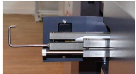
Die 375 Pro von Ausjetech ist die schnellste Rill-/Perforiermaschine im Angebot von dmsDigital. Der Werkzeugwechsel am System erfolgt per Slide-in-Technologie.
