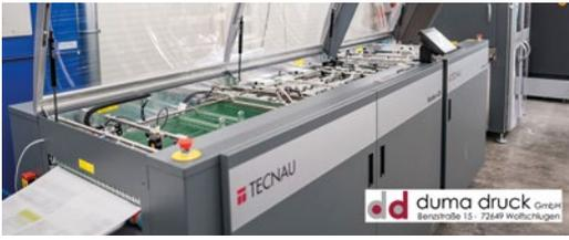
Die Tecna Stack 2328 Doppelschnitt- und Langformat-Stapellösung INline an der Xeikon SX30000-Druckmaschine bei Duma Druck.
