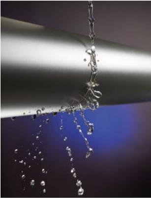
Das Beschichtungssystem Lototec ahmt mit seiner speziellen mikrostrukturierten Oberfläche die Eigenschaften des Lotosblattes nach und ist nicht wasserbenetzbar. Dadurch ergeben sich eine Reihe vorteilhafter Effekte für den Offsetdruck.
