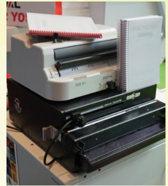
...Bindegerät Magnopro Finish Crimp+Coil, hier im Verbund mit einer Elektrostanze Rhin-O-Tuff Onyx OD 4012 zu sehen.
