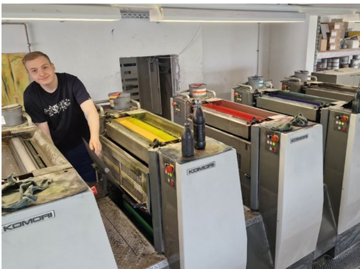
Drucker Max arbeitet schnell und effizient auf der Komori Fünffarben-Druckmaschine, weil der Cron-Belichter perfekt registergestanzte Druckplatten liefert.
