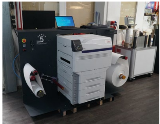
Der 5-Star Eco-Line ist ein neuer Rollenetikettendrucker im Programm von PrintsPaul. Das tonerbasierte 5-Farbsystem schafft 11,2 Meter pro Minute bei 600x600 dpi.
