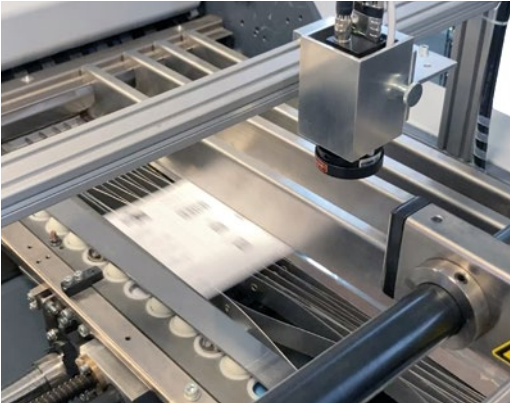
Inspektion von Druckprodukten: kvInspect von Kaiser Vision ist schnell in Printfinisingsysteme installiert.
