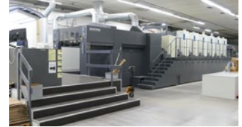
Hohe Qualitätsstandards setzt man bei Schwab im Offsetdruck mit einer Roland 906 LV HiPrint im Großformat bis 1.020 x 1.420 mm.
