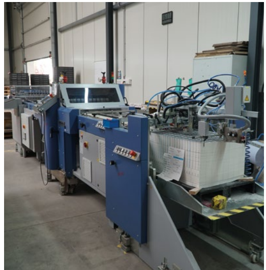
Die rotative Stanzmaschine BSR 550 Servo von Bograma zeichnet sich durch einfache Werkzeugtechnik, kurze Rüstzeiten und hochpräzise Passgenauigkeit aus.
