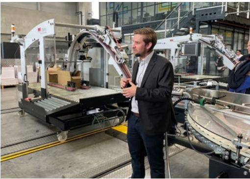
Der Diana Smartpacker ist für bis zu 130.000 Kartons pro Stunde ausgelegt.
