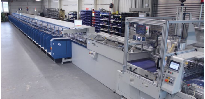
Mit 40 Stationen und integriertem Labeldrucker sowie einer gekoppelten Folienverpackungsmaschine wurde der MKW Smart Collator im Juni ausgeliefert.
