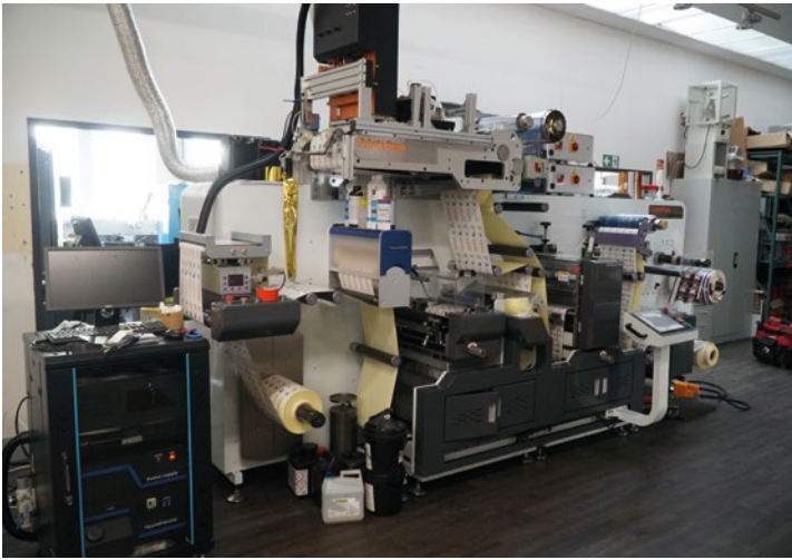
Eine PP-MDF-330-Etiketten-Weiterverarbeitungsmaschine mit Folienveredelung auf Inkjet-Basis und Rotationsstanzwerk mit Smart-Gap-Funktion. PP-MDF steht für PrintsPaul Modular Digital Finisher, 330 steht für die Bahnbreite.
