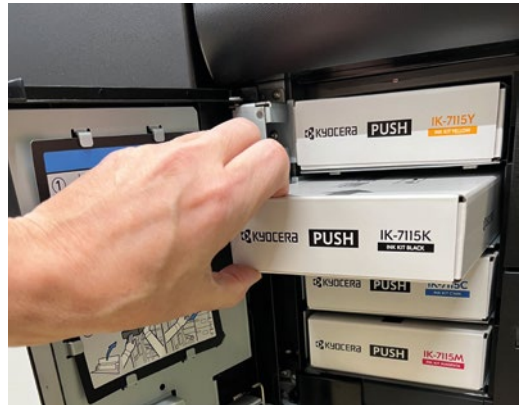
Sekundenschneller Tintenkartuschenwechsel. Bei gutem Timing kann er im laufenden Betrieb erfolgen, da ein Puffersystem eingebaut ist.
