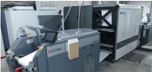
Gedruckt wird, wie hier in Deizisau, auf einer Domino K630i mit Auf- und Abrollern aus dem Hause Tecna.
