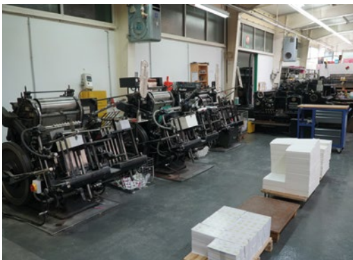
Mehrere Tiegel und Cylinder unterstützen die Fertigung im Drucksaal. Die Oldtimer kommen vor allem bei Kleinauflagen zum Einsatz.
