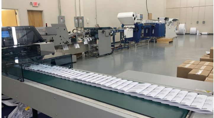
Die neue Hohner-Futura-Produktionsstrecke von Schwabenprint LLC in Virginia Beach fertigt seit August Betriebsanleitungen mit bis zu 5,5 Mio. Seiten pro Tag.
