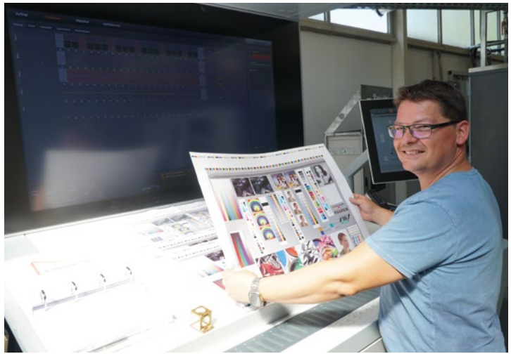
Betriebsleiter Lars Roth ist sichtlich zufrieden mit dem neuen Großleitstand mit Wallscreen. Die Speedmaster XL75 kann darüber hinaus noch mit weiteren modernen Features glänzen, darunter eine Inline-Farbmessung.
