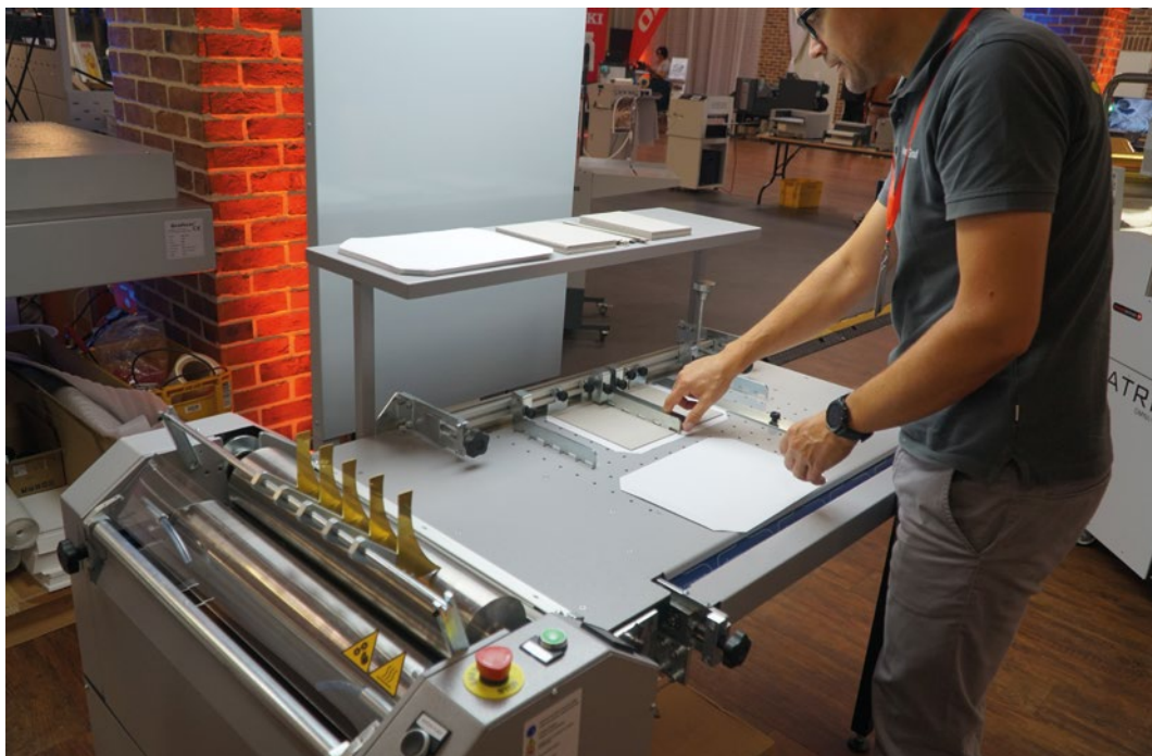
Andreas Graf, Geschäftsführer von dmsDigital, demonstriert hier die flexible Hardcoverproduktion mit dem GC-480 Compact. Links im Bild das Leimaufragsmodul. Auch andere kaschierte Produkte lassen sich damit herstellen.
