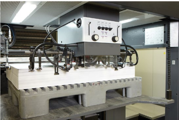
Elektrostatik kann Probleme am Anlagestapel machen.
