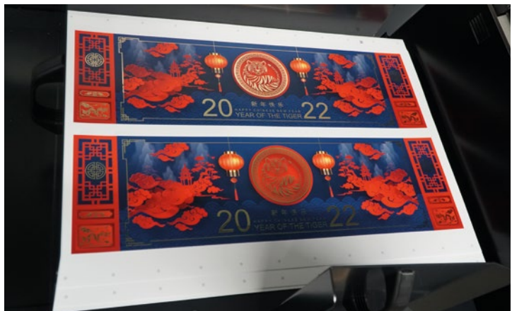
Mit UV-Spotlack in variablen Schichtdicken und Spotfolierung, zum Beispiel mit Metallfolien, erzeugt die DDC-8000 beeindruckende Effekte.
