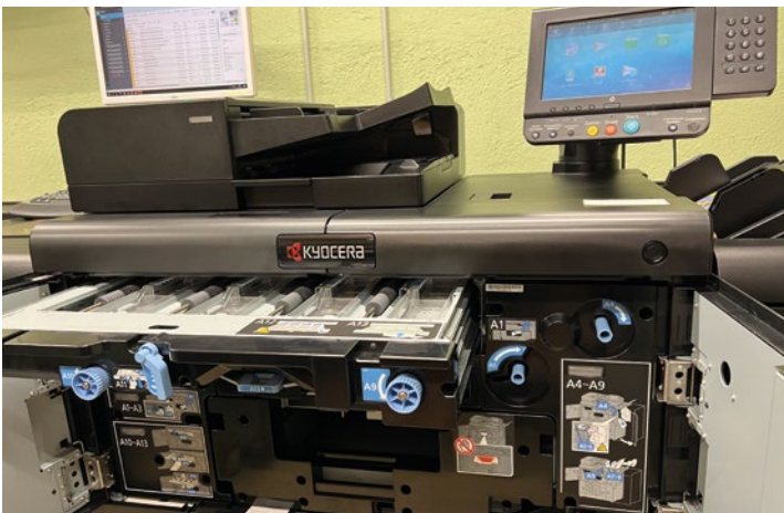
Die Kyocera TaskAlfa Pro 15000c mit geöffneter Übergabeeinheit zur Wendung für den Duplexdruck. Darunter verbergen sich die Druckköpfe.
