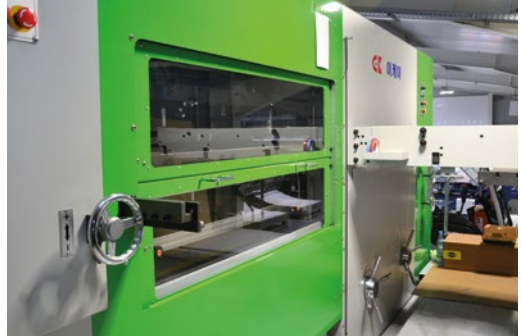
Der Stanzautomat Enko 1800 kommt aus dem Hause Staper Europe und verarbeitet bis zu 3.800 Bogen/h.
