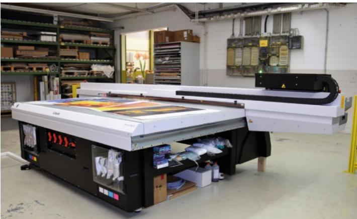
Großformatiger Werbedruck: Das achtkanalige UV-Inkjet-Drucksystem Canon Arizona 1380 GT ist seit Juli 2023 bei Frielingsdorf in Wuppertal erfolgreich im Einsatz.
