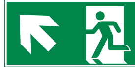
Rettungsweg links aufwärts
