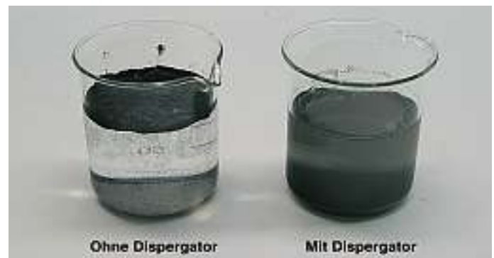
Abb. 11: Dispergatoren erleichtern die Benetzung von Grafit mit Wasser
