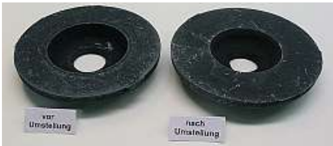
Abb. 19: Sandanhaftungen vor und nach der Umstellung
