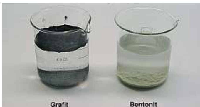
Abb. 10: Dispergieren von Bentonit und Grafit in Wasser
