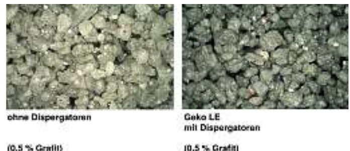
Abb. 13: Dispergatoren gewährleisten eine homogene Umhüllung der Quarzkörner mit Grafitlamellen während der Formstoffaufbereitung
