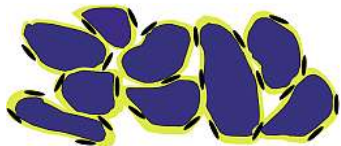
Abb. 12: Gleichmäßige Umhüllung der Quarzkörner mit einer dünnen Grafitsschicht
