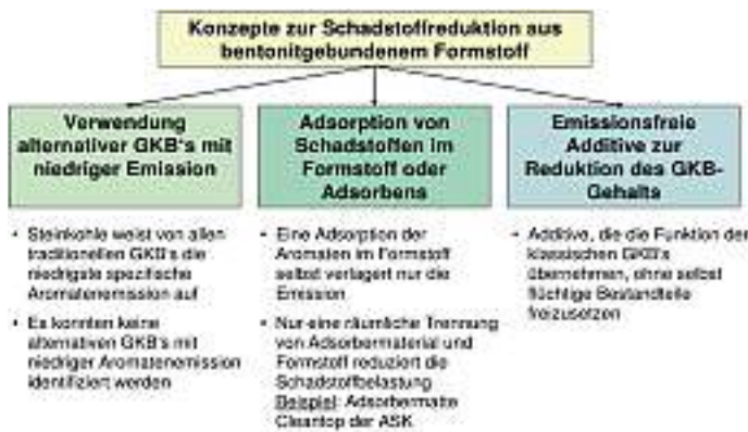
Abb. 8: Konzepte zur Schadstoffreduktion aus bentonitgebundenem Formstoff
