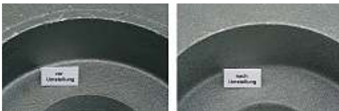
Abb. 20: Oberflächengüte bei 50 %igem Austausch
