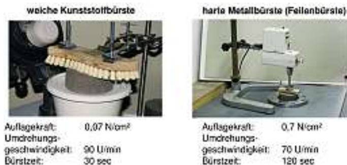
Abb. 15: Bürsten der Testscheiben
