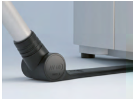
Die 12 (!) mm Ultraflach-Saugdüse arbeitet mit 8 Sauglöchern und deckt 22 x 4 cm Saugfläche in einem Zug ab.
