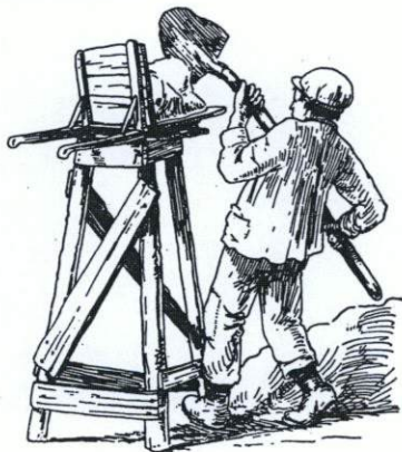
Fig. 704 : trèpi de maçon.
