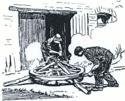
Fig. 663 : la roue, construite par le tchârli , est livrée au mar'hâ qui procède au cerclage, tandis que l'on verse de l'eau sur le fer rougi.
