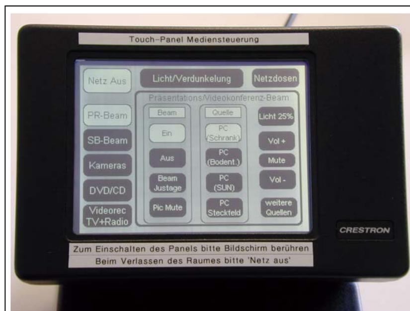
Abb. 5: Bedienpanel der Mediensteuerung
